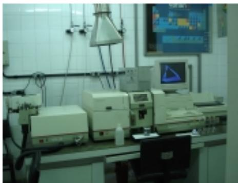
**Figura 4.2 - Espectrofotômetro de Absorção Atômica**
