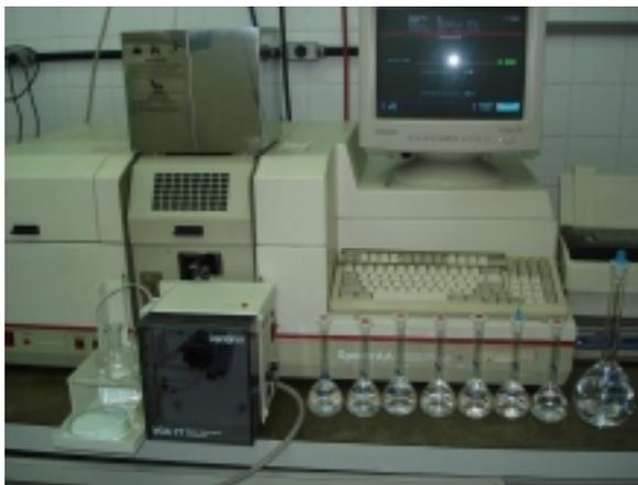
**Figura 4.8** representação do gerador de hidretos, método Vapor-frio.
