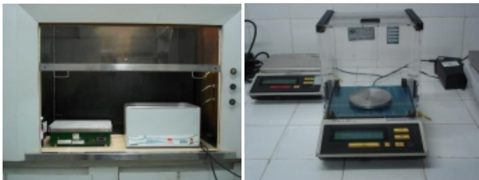
**Figura 4.3 - chapa aquecedora, banho Maria e balança analítica.**
