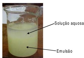
Figura 6.12: Foto que mostra a existência de duas fases bem definidas de PVA e retinal.
