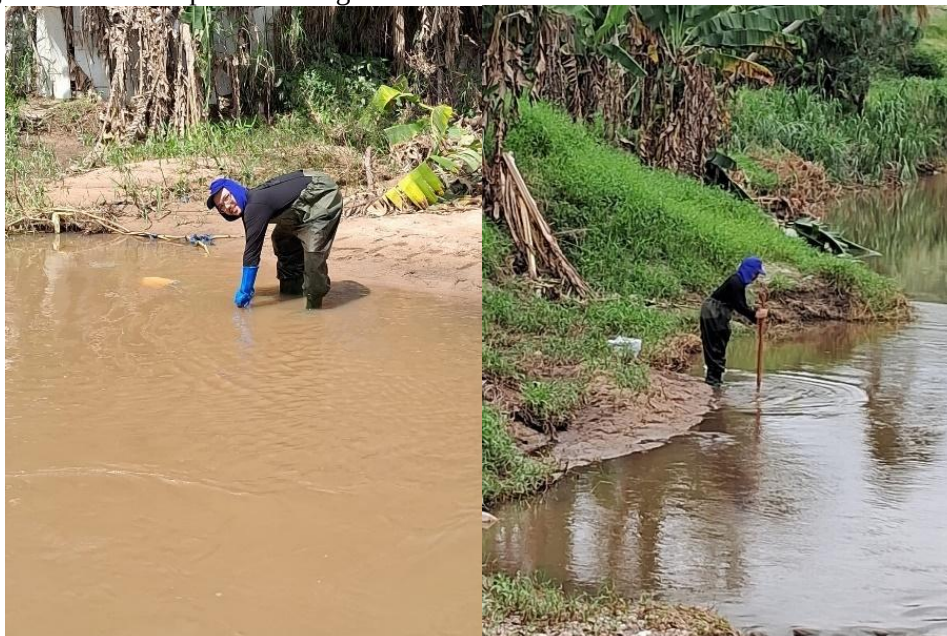
Figura 29 – Coleta para análise granulométrica das amostras de sedimento do rio Natuba
