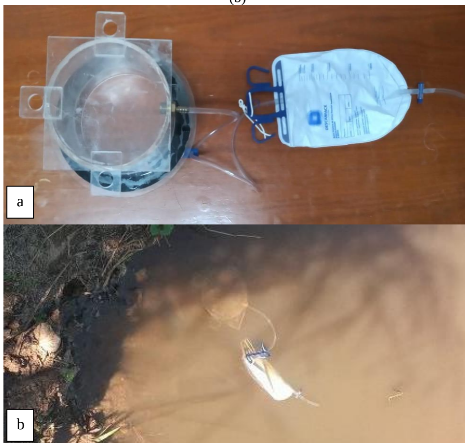
Figura 27 – Visualização do cilindro de infiltração em leito de rio (a) e a execução do teste em campo (b)
