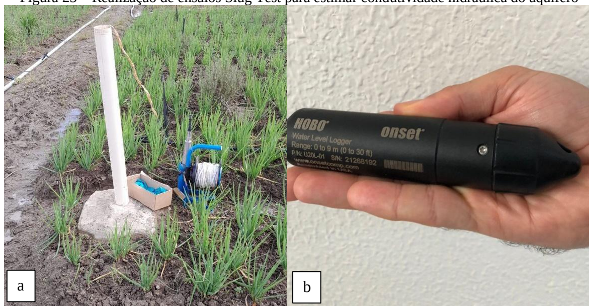
Figura 25 – Realização de ensaios Slug Test para estimar condutividade hidráulica do aquífero
