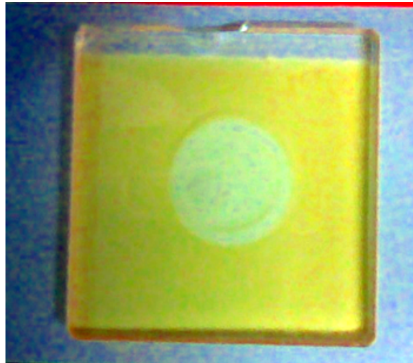
Figura 5.13 Amostra Ag20 após o processo de polarização eletrotérmica, onde observamos um clareamento na posição de polarização na parte central, onde foi posicionado os eletrodos.
