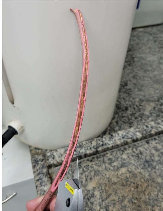
Figura 21. Cabo de formação com fiação de cobre exposta.
