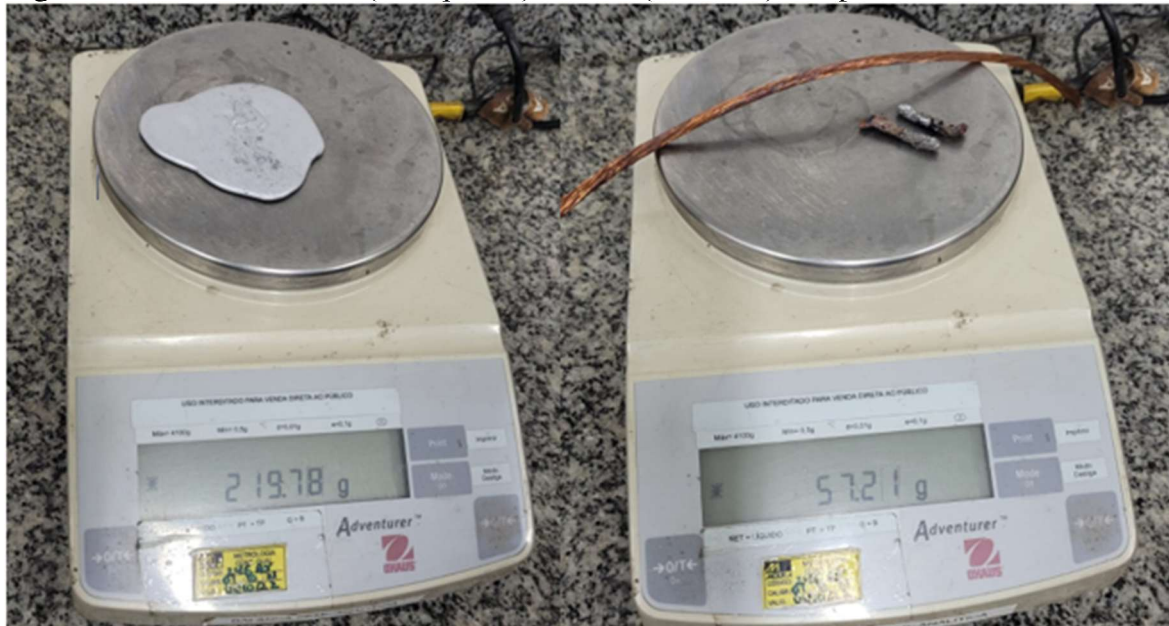
Figura 22. Peso do chumbo (A esquerda) e cobre (A direita) recuperados do cabo de formação
