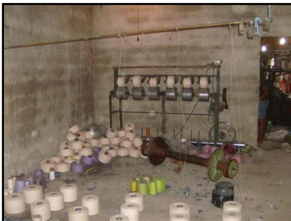
**Foto 24:** Tacaratu: "Enrrocadeira" ou máquina utilizada para preparar os fios para urdição.
