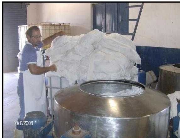
**Foto 2:** Jardim de Piranhas: centrífuga usada para secagem de tecido.
