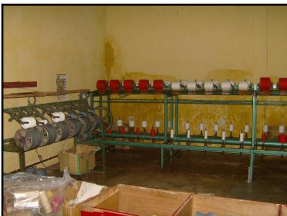
**Foto 25:** São Bento: Conicaleira industrial à esquerda e à frente Conicaleira inventada localmente para ampliar a produtividade.
