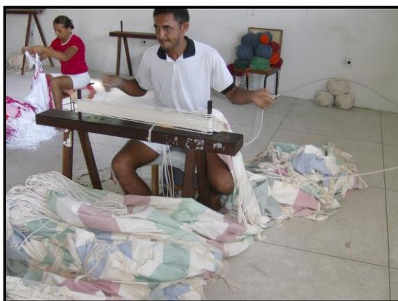
**Foto 11:** São Bento: empunhamento ou colocação dos cordões que formam o punho da rede de dormir.
