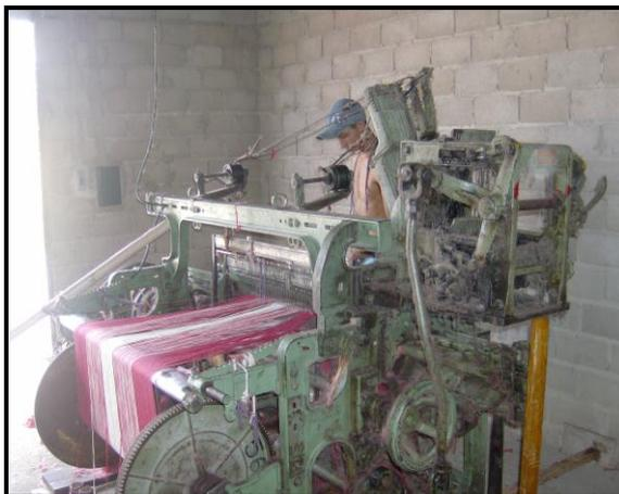
**Foto 16:** Tacaratu: fabricação de tapete em tear elétrico
