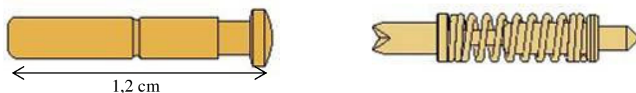
Fig. 2.5: Ilustração dos eletrodos utilizados para fazer os contatos sobre a superfície do filme, mostrando os detalhes da mola.
