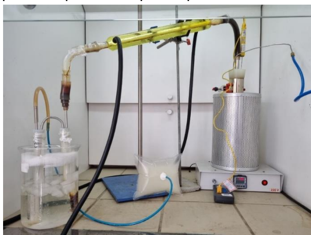
Figura 9 - Aparato experimental para a pirólise em escala de bancada.
