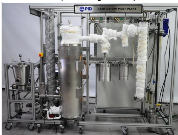
Figura 10 - Unidade minipiloto de gaseificação PP1704IPT (PID).
