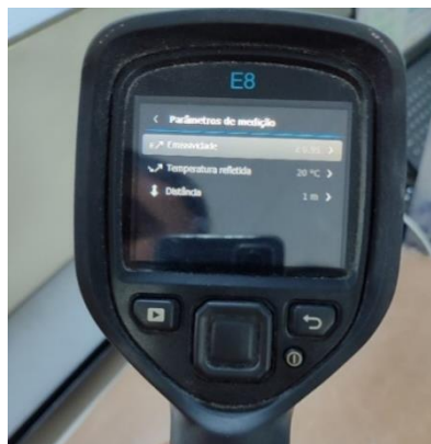
Figura 50 – Parâmetros definidos na câmera termográficas.
