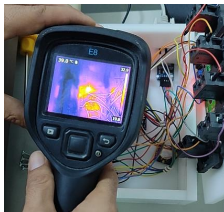
Figura 51 – Registro da temperatura inicial do sistema.
