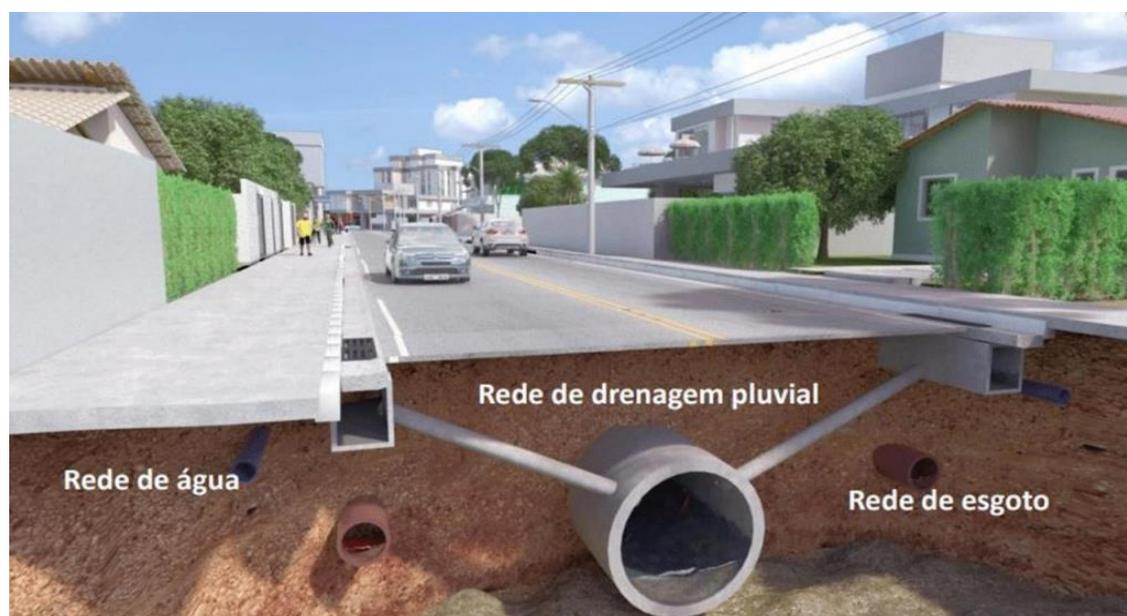
Figura 2 – Ilustração dos sistemas de abastecimento de água, drenagem e esgotamento sanitário. Fonte: Jornada de adoção, Imagem Esri.
