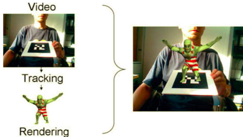
Figura 18 – Rastreamento e Renderização de um objeto 3D sobre um marcador fiducial
