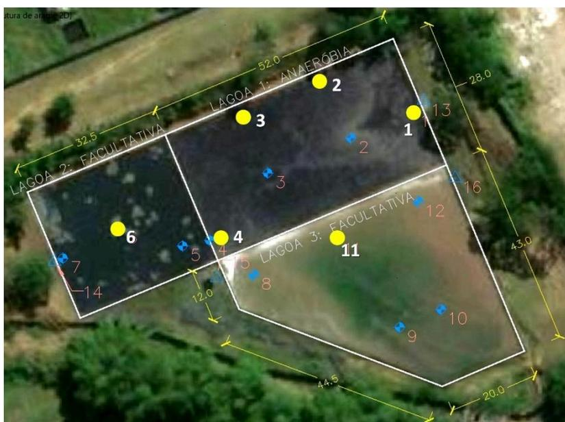
**Figura 3.** ETE multifabril do Jaboatão dos Guararapes com demarcação dos 12 pontos de coleta. (Fonte: Autor)
