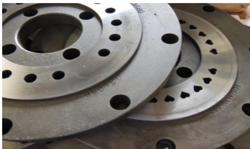
Figura 9 - Matriz de formação de kibble no sistema de extrusão corte.
