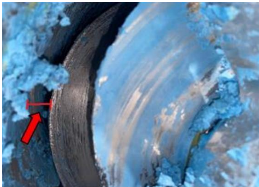
Figura 11 - Evidência da folga entre a trefila e a parede da cavidade.
