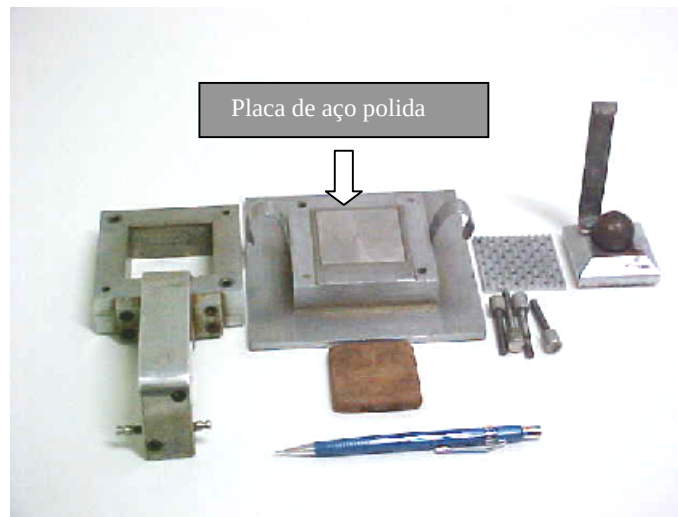
Figura 4.9. Peças utilizadas no ensaio de cisalhamento direto com interface lisa.
