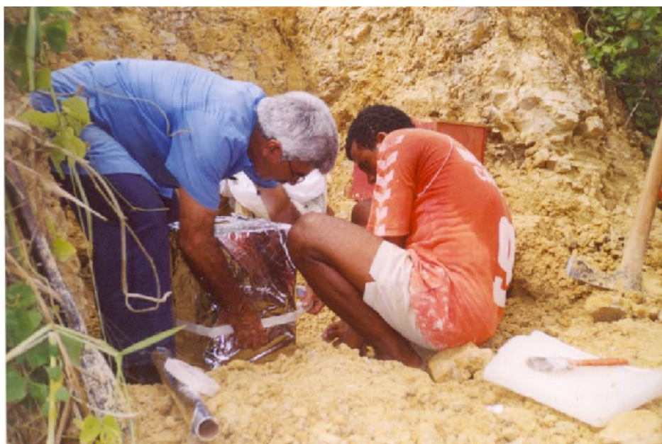
Figura 3.14. Preparação do bloco para parafinagem.
