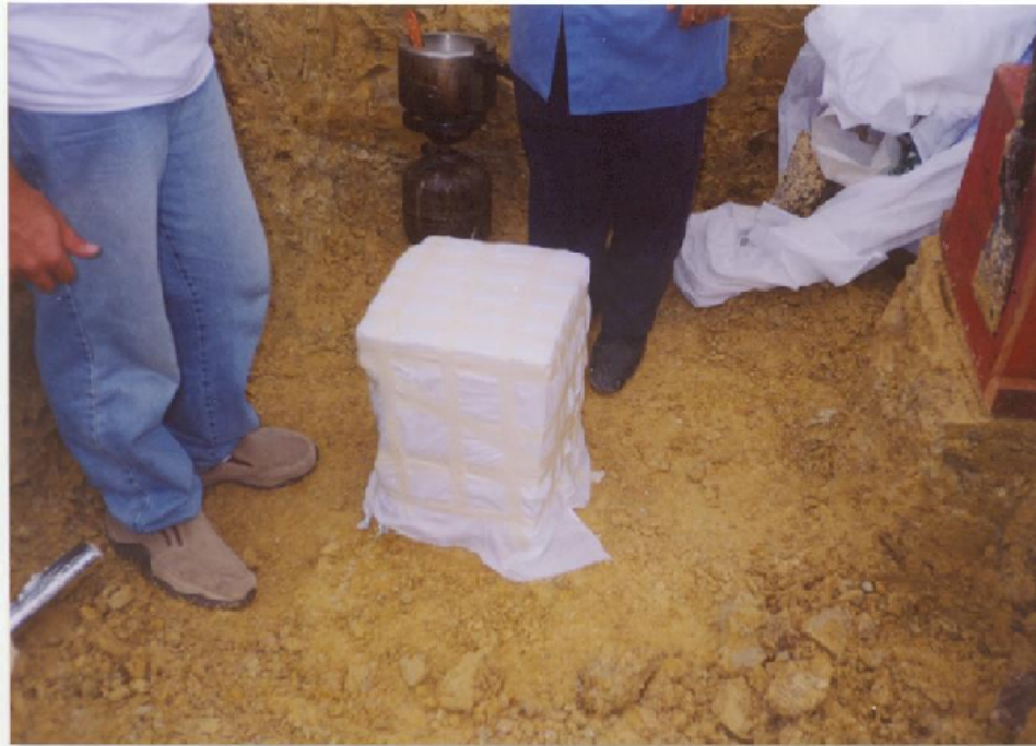
Figura 3.15. Preparação do bloco para parafinação.
