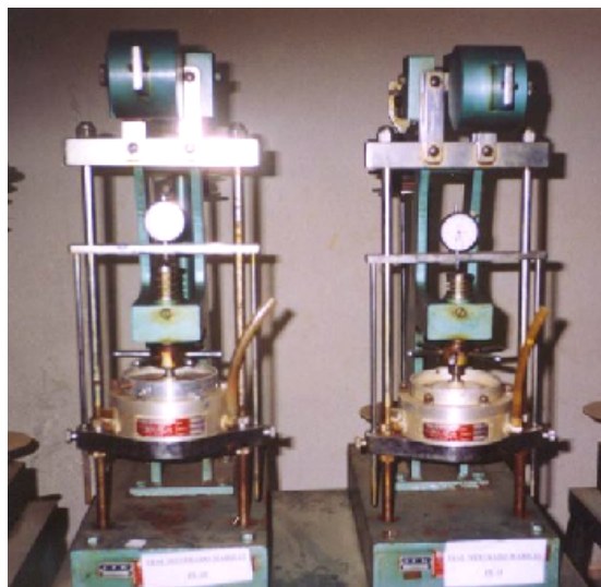
Figura 4.5. Prensas de adensamento.
