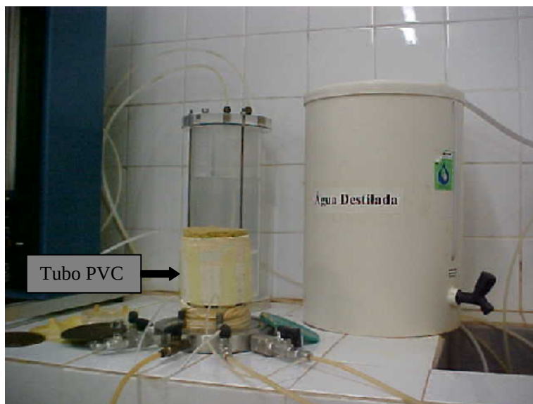
Figura 4.3. Colocação do tubo de PVC no corpo de prova saturado no Tri Flex-2.
