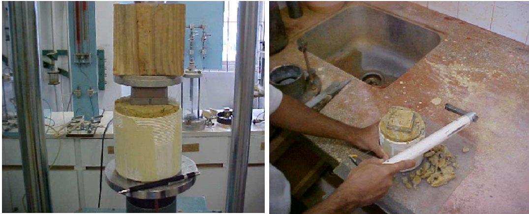
Figura 4.7. Cravação do moldador no solo. Figura 4.8. Seccionamento da base da amostra.
