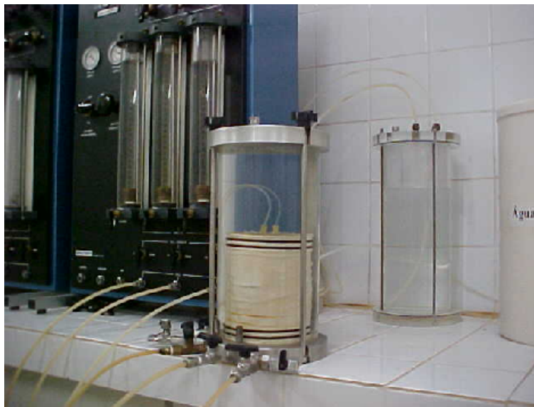
Figura 4.2. Detalhe do corpo de prova na célula de acrílico do equipamento Tri Flex-2.
