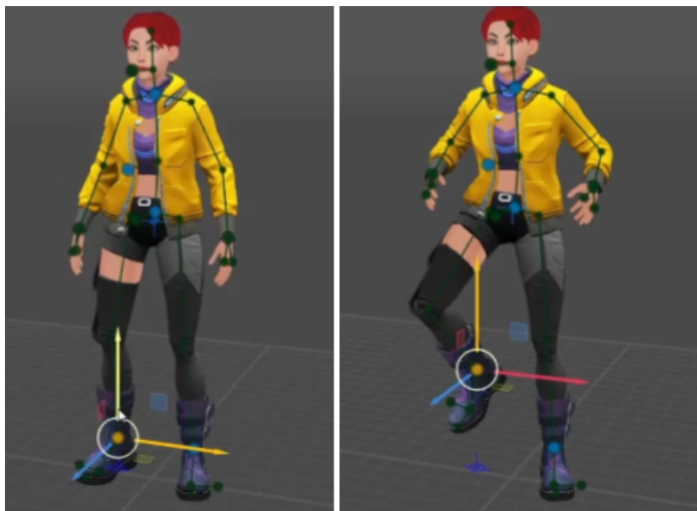
Figura 3 - Cascadeur automaticamente movimenta os outros ossos da malha apenas ao movimentar o pé direito.
