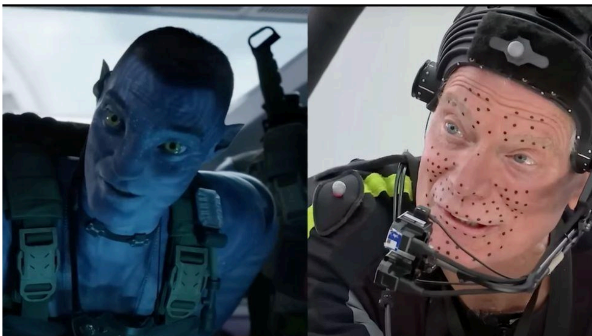
Figura 2 - Motion Capture utilizado na indústria de filmes para captar expressões faciais
