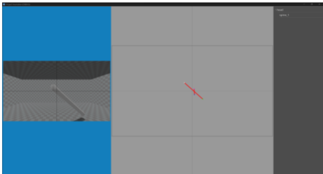
Figura 22 - Desenho da reta atualiza o transform do objeto. À direita, aparece o novo osso que pode ser selecionado para ser desenhado.
