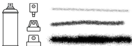
Figura 4.17. Spray . Espessuras diferentes feitas com tinta em spray podem ser justificadas pelo tipo de cap utilizado. Fonte: autora.
