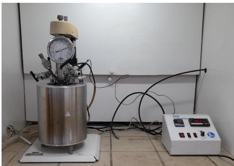
Figura 1: Reator utilizado para os experimentos de liquefação térmica
