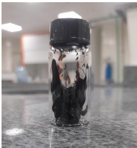
Figura 3: Bio-óleo obtido na liquefação térmica
