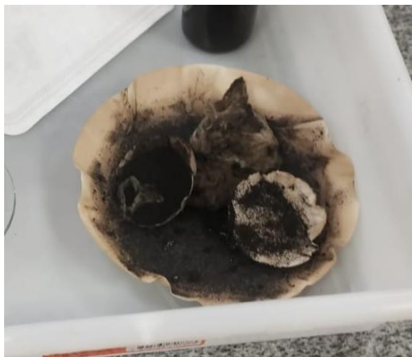
Figura 2: Fase sólida obtida ao final da reação – biochar
