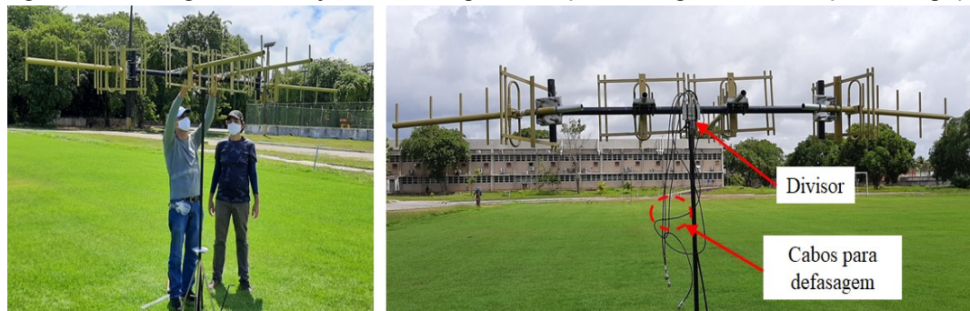
Figura 44- Montagem do arranjo de antenas para medição do diagrama de radiação em espaço
