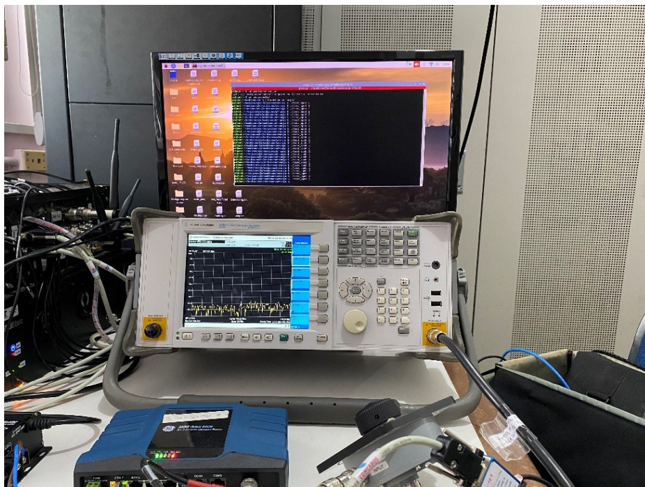
Figura 69- Teste da chave SPDT com o rádio conectado na entrada JC e o analisador de spectrum na saída J1. A chave SPDT está configurada para a saída J2
