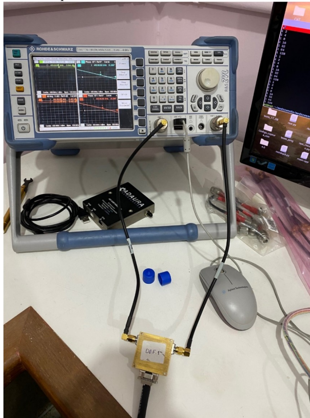
Figura 58- Teste do atenuador digital conectado ao VNA controlado pelo CAT
