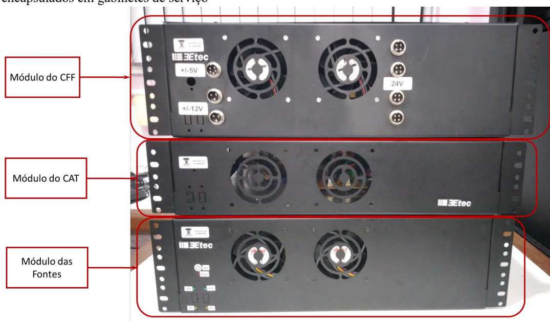
Figura 99- Perspectiva frontal dos módulos do sistema de antenas inteligentes sobrepostos encapsulados em gabinetes de serviço
