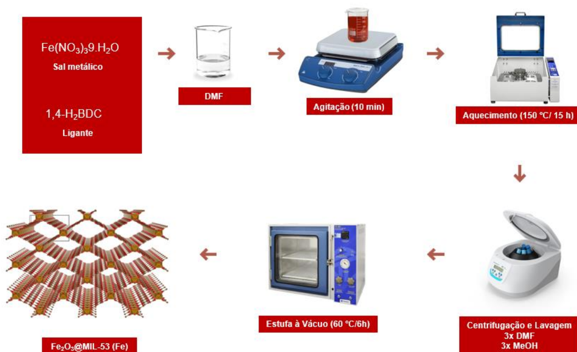
Figura 7 – Esquema de síntese para o precursor \text{Fe}_2\text{O}_3@\text{MIL-53 (Fe)}
