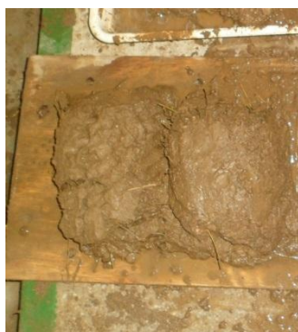
Figura 40- Comparação entre tijolo referência X tijolo com adição de baba.
