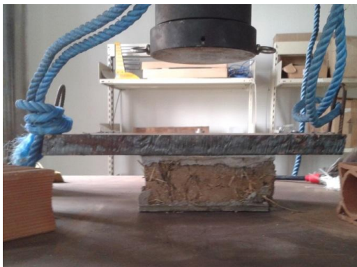
Figura 35 - Máquina de ensaio mecânica (prensa), antes da aplicação da carga
