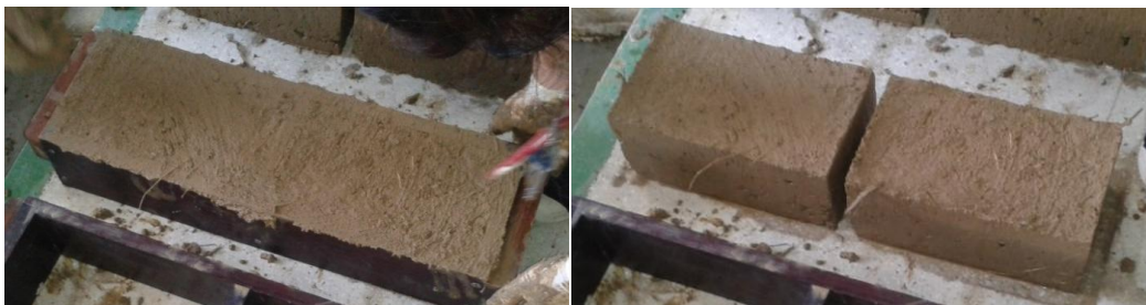
Figura 26 - Desmoldagem do tijolo Adobe.
