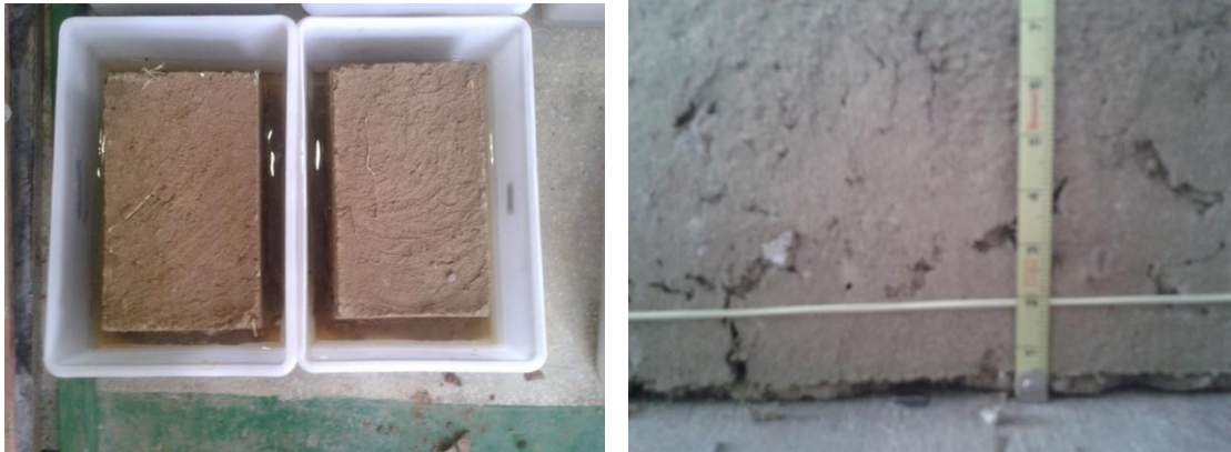
Figura 31 - Ensaio de Capilaridade
