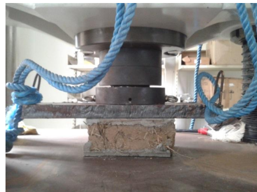
Figura 35 - Máquina de ensaio mecânica (prensa), antes da aplicação da carga
