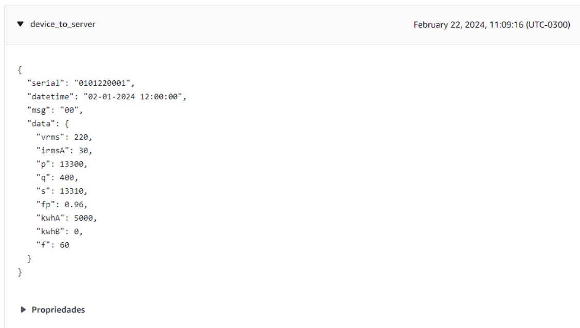
Figura 71 – Simulação de uma mensagem do dispositivo publicada através do MQTT Test Client .
