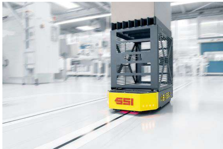
Figura 1 – Robô seguidor de linha industrial, Weasel da SSI SCHAEFER.
