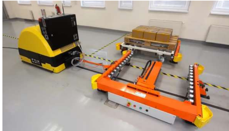
Figura 2 – Robô seguidor de linha industrial, Tow Tractor da CEIT.
