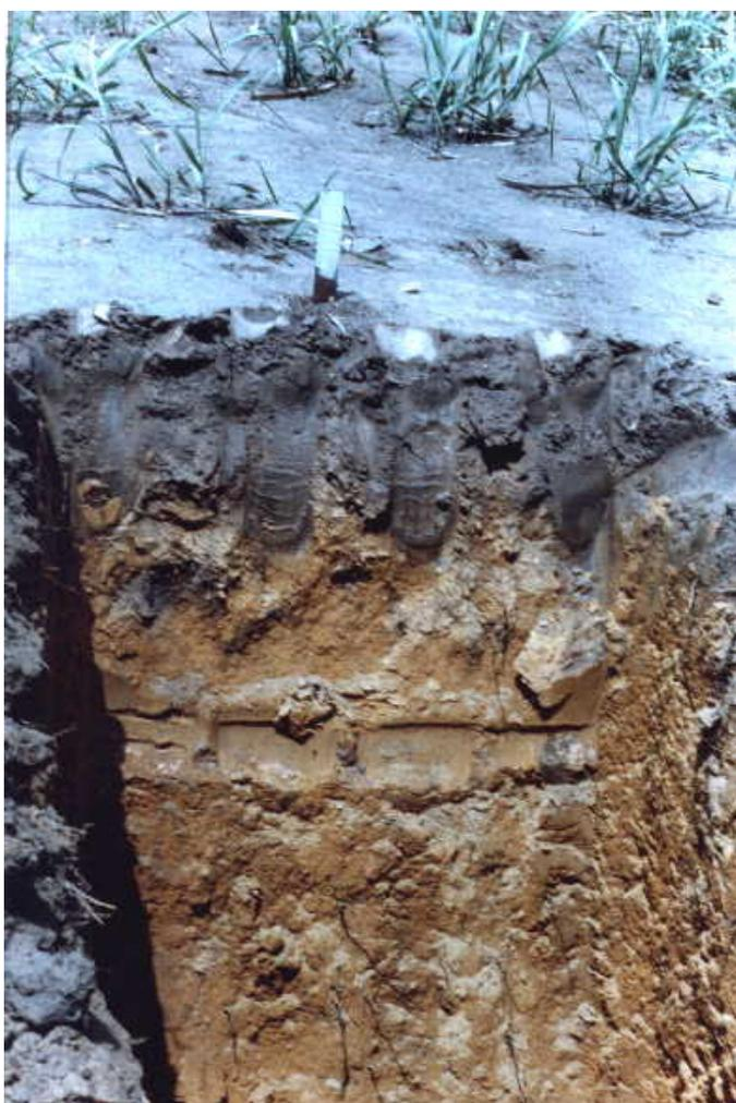
Foto 04: Abertura de vala. Detalhe das camadas de argila da Formação Barreiras.
