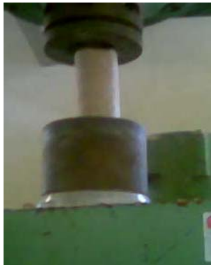
Figura 3.4 – Ensaio de resistência à compressão
