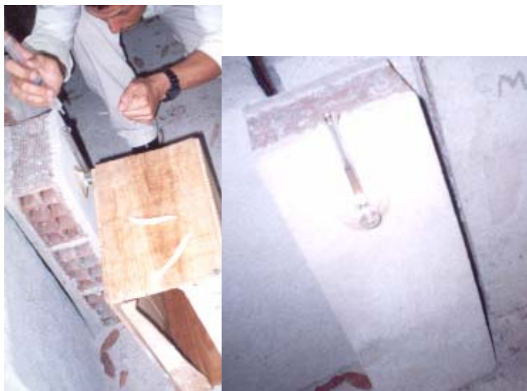
Figura 3.8 – Ensaio de permeabilidade
