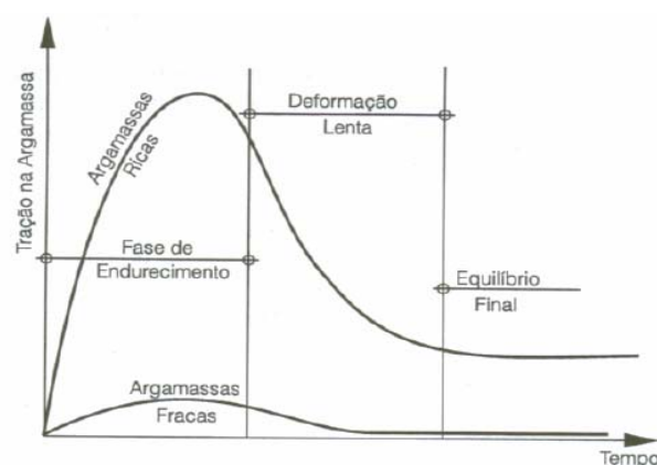
Figura 2.9 – Comportamento das tensões nas argamassas, FIORITO (1994)
