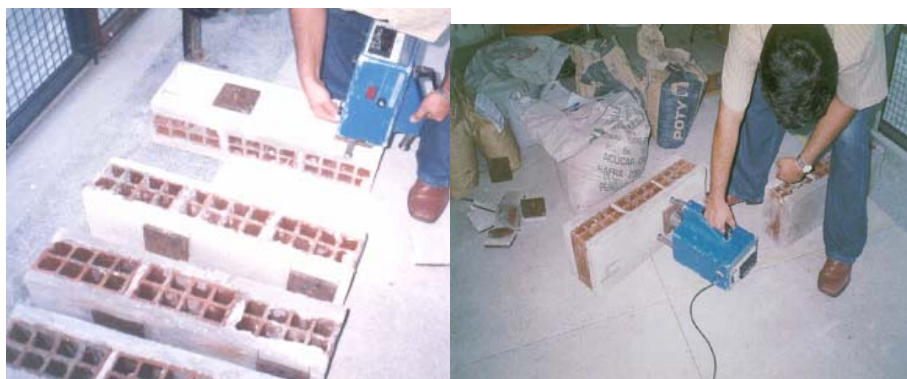
Figura 3.9 – Ensaio de resistência de aderência à tração
