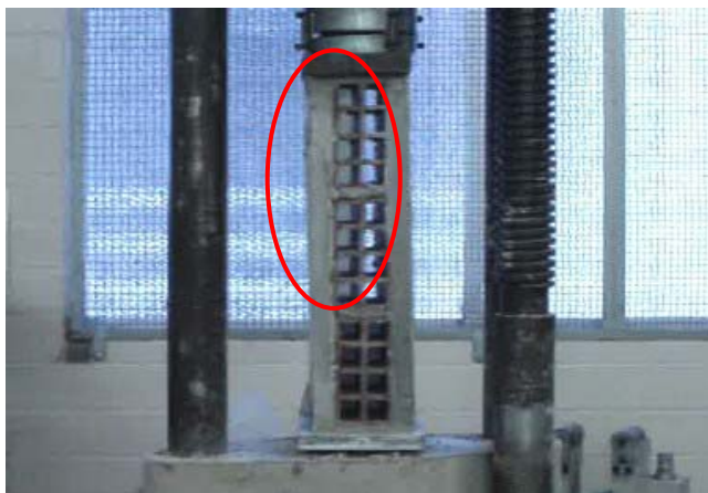
Figura 6.12 (a) – Prisma com 3 cm de revestimento no instante 1 posterior à ruptura
