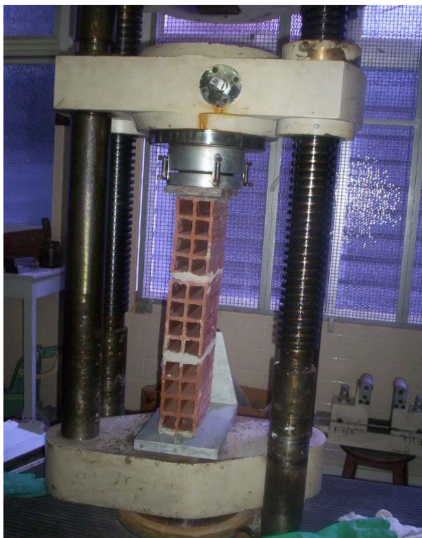
Figura 2.17 (b) – Prisma com três blocos de vedação
