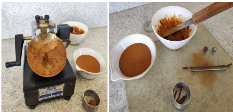
Figura 08 - Ensaios de Limites de Atterberg – Limite de liquidez e plasticidade, respectivamente
