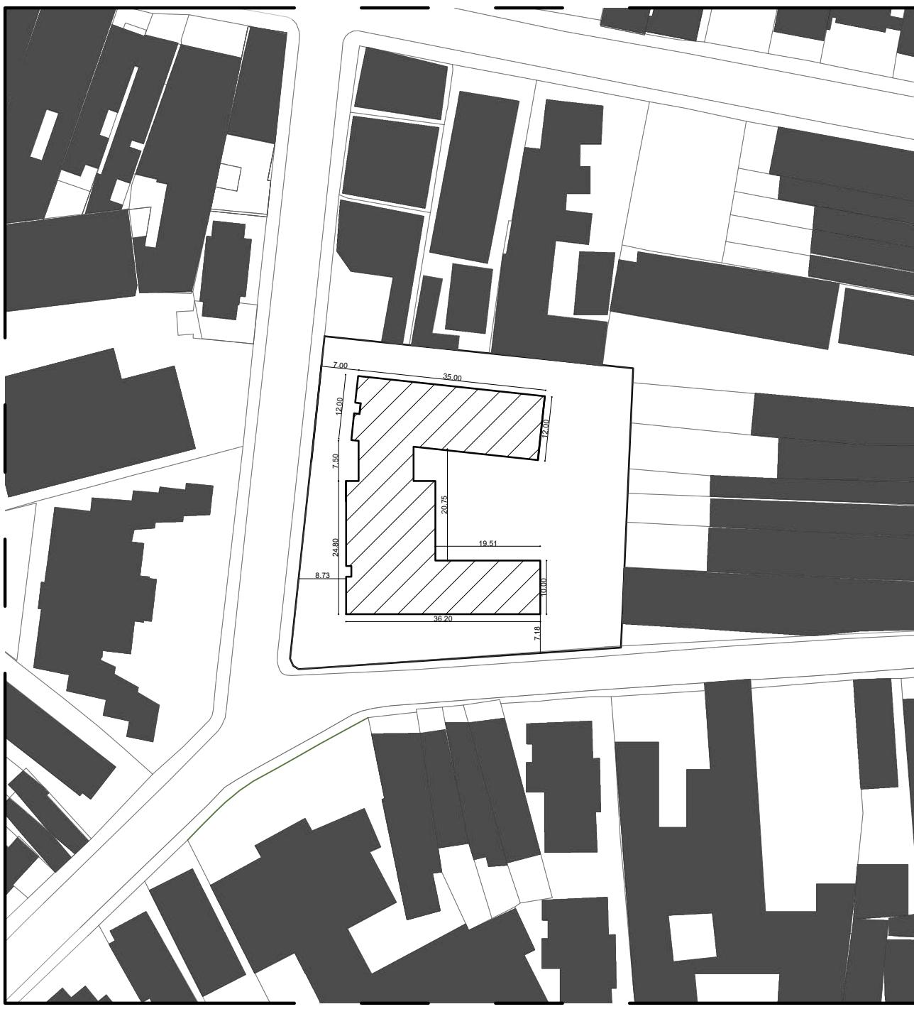
PLANTA DE SITUAÇÃO ESCALA: 1/1000
