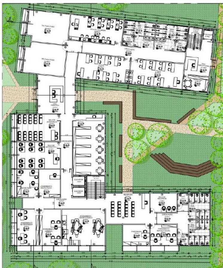
Figura 76 - Planta baixa do primeiro pavimento.
