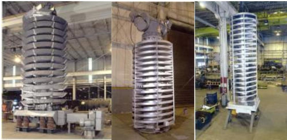
**Figura 4-7 – Transportadores Helicoidais** (Fonte: Carrier)
