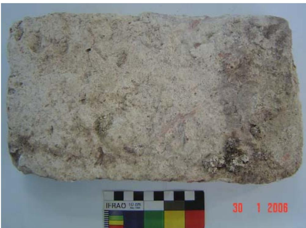
Foto 74: Tijolo de barro com material calcário aglutinado, observar as proporções 29x19x7 cm.
