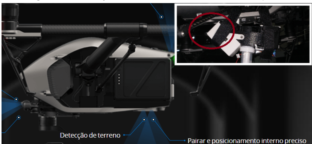
Figura 11 - Localização e alcance de sensores no drone DJI Inspire 2.
