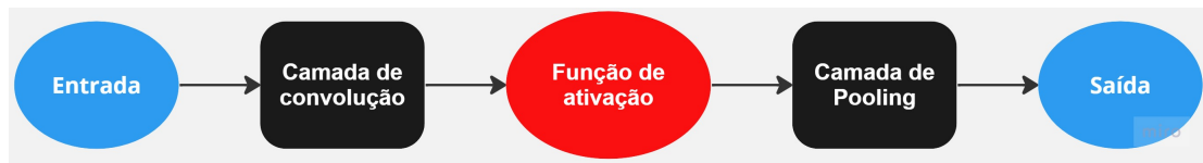
Figura 2.7 – Representação esquemática da estrutura da Base de extração de características de uma RNC.
