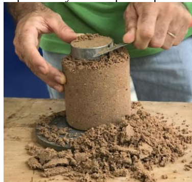
Figura 18 - Cravação dos anéis tipo Shelby nos corpos de prova na umidade ótima
