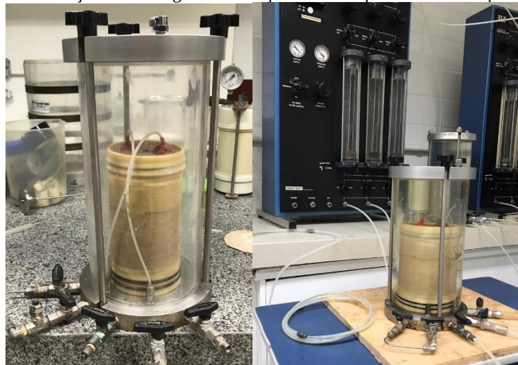
Figura 16 - Finalização da montagem e saturação da célula para o ensaio de permeabilidade
