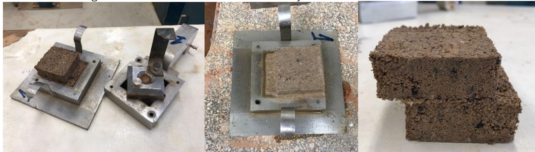
Figura 27 - Amostras cisalhadas na condição natural e inundada
