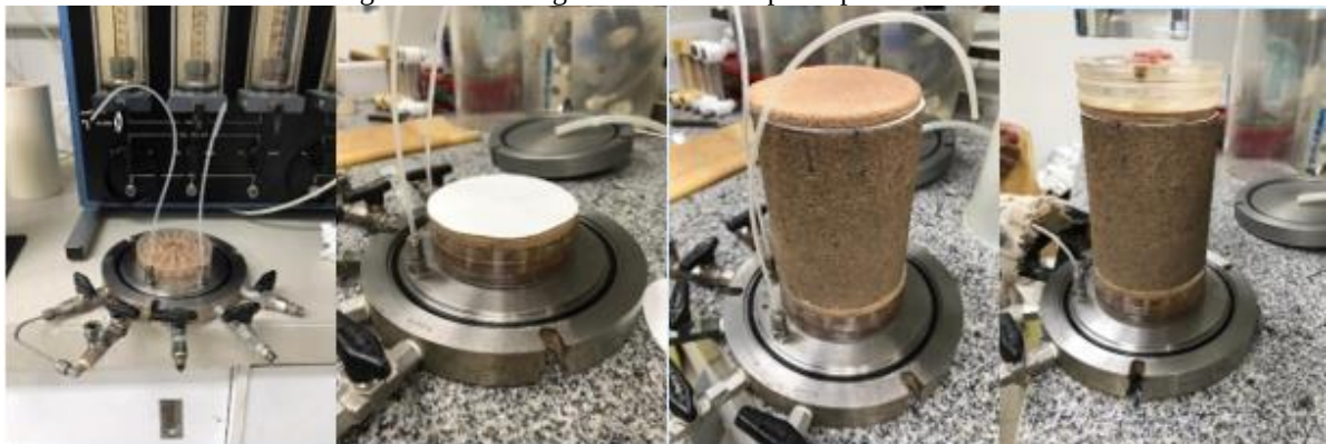
Figura 14 - Montagem inicial do corpo de prova na célula
