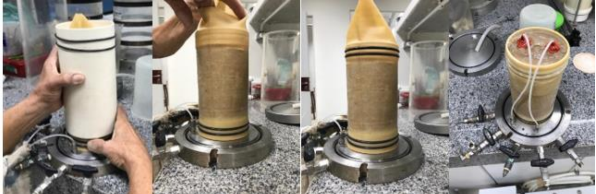
Figura 15 - Procedimento de montagem da amostra no permeâmetro de parede flexível modelo Tri-flex 2 da Soil Test – ELE
