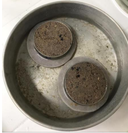
Figura 19 - Amostras em processo de saturação
