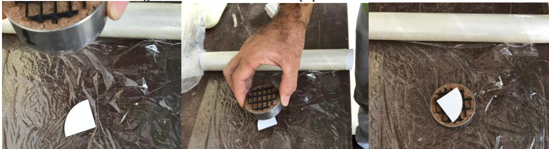
Figura 20 - Posicionamento do papel filtro na amostra
