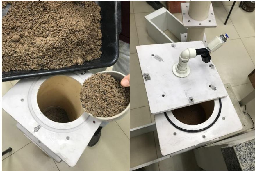
Figura 30 - Colocação das misturas dentro das colunas com detalhe para o seu topo e fechamento
