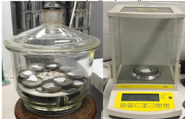
Figura 22 - Papéis no dessecador e pesagem após secagem na estufa
