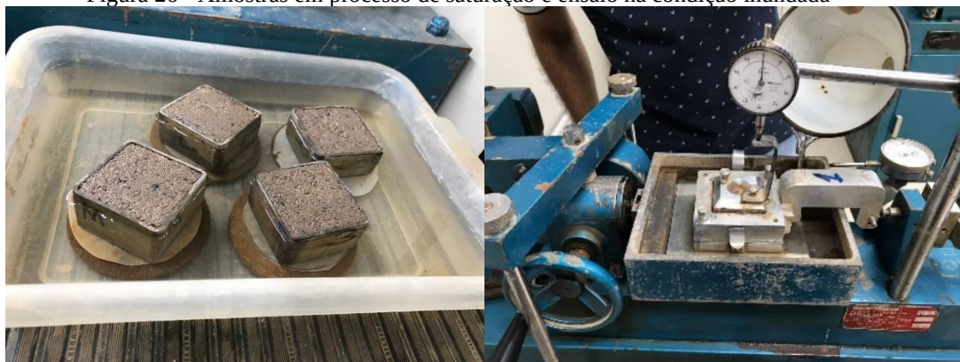
Figura 26 - Amostras em processo de saturação e ensaio na condição inundada
