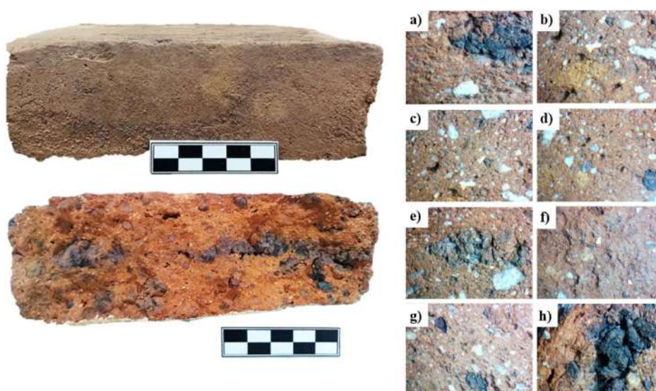
Figura 235: Aparência e uso do carvão como antiplástico para os tijolos do século XVII
