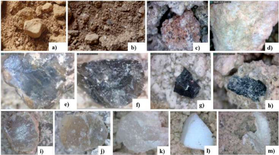
Figura 246: Tipos de argamassas encontradas durante os estudos de caso desta tese; (a, b, d) aumento de 25x; demais imagens a um aumento de 50x
