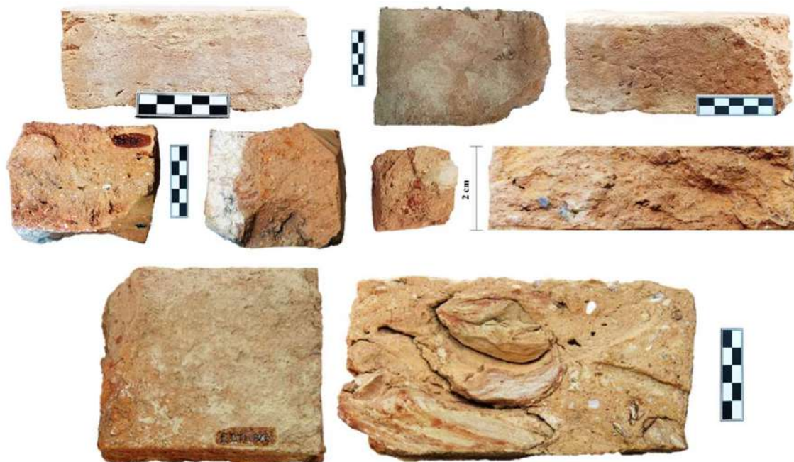
Figura 236: Aparência e uso dos bolos de cal e argila como antiplástico para os tijolos da primeira metade do século XVII
