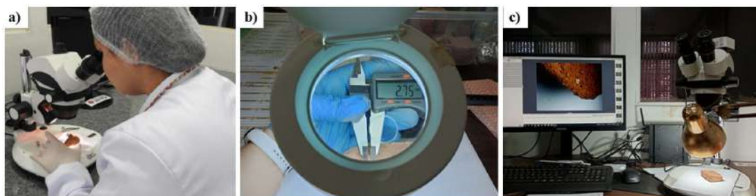
Figura 230: Instrumentos de observação macroscópica dos materiais construtivos estudados; (a; c) observação com estereoscópio; (b) observação com lupa de aumento
