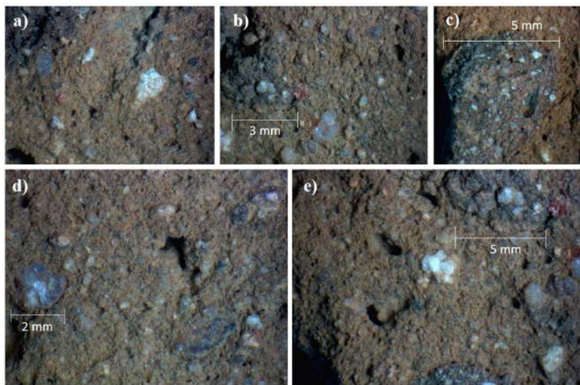
Figura 238: Pasta cerâmica dos tijolos do século XVII da moradia nº18, Vila de Nazaré, aumento de 25x
