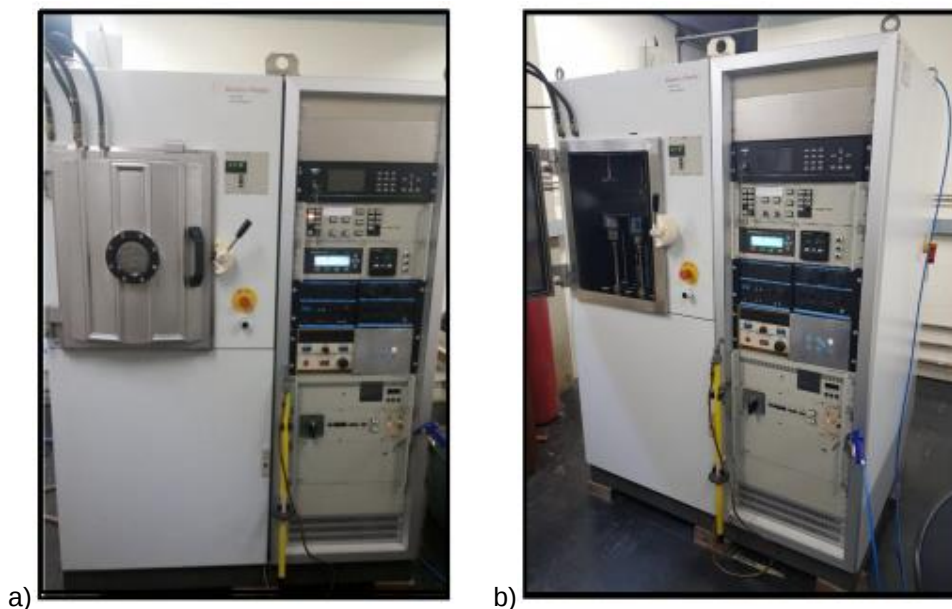
Figura 33 - Equipamento de sputtering utilizado na deposição (a) com câmara de vácuo fechada (b) com câmara de vácuo aberta
