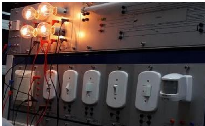
Figura 14 - Ligações entre lâmpadas: Bancada de instalações elétricas (DK8).
