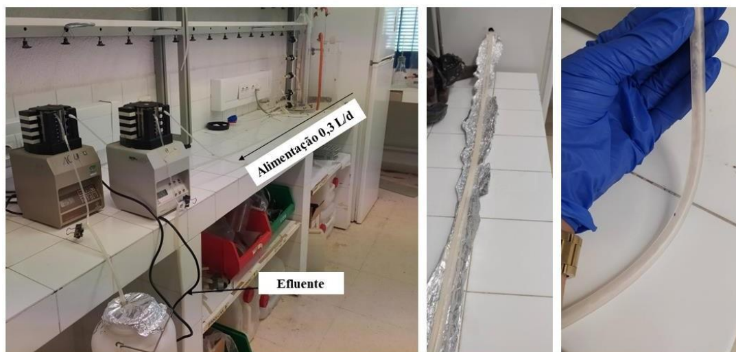
Figura 7 - Sistema experimental de alimentação das mangueiras para crescimento do biofilme
