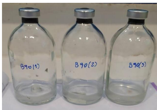
Figura 8 - Experimentos em batelada variando a concentração de H 2 e glicerol
