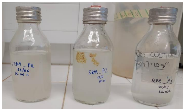
Figura 6 - Frascos anaeróbios utilizados nas transferências para ativação do inóculo
