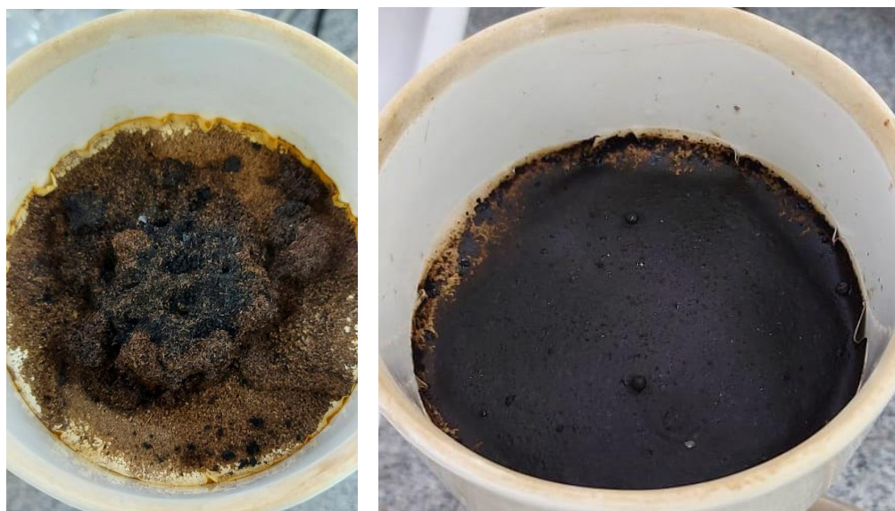
Figura 10 – Sólidos molhados formados de uma reação sem a presença de um catalisador (à esquerda) e com a presença de catalisador (à direita).
