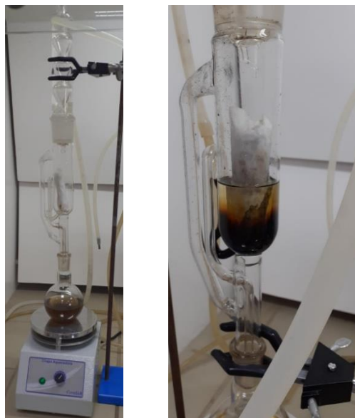
Figura 3 – Etapa de recuperação do bio-óleo utilizando o extrator Soxhlet.
