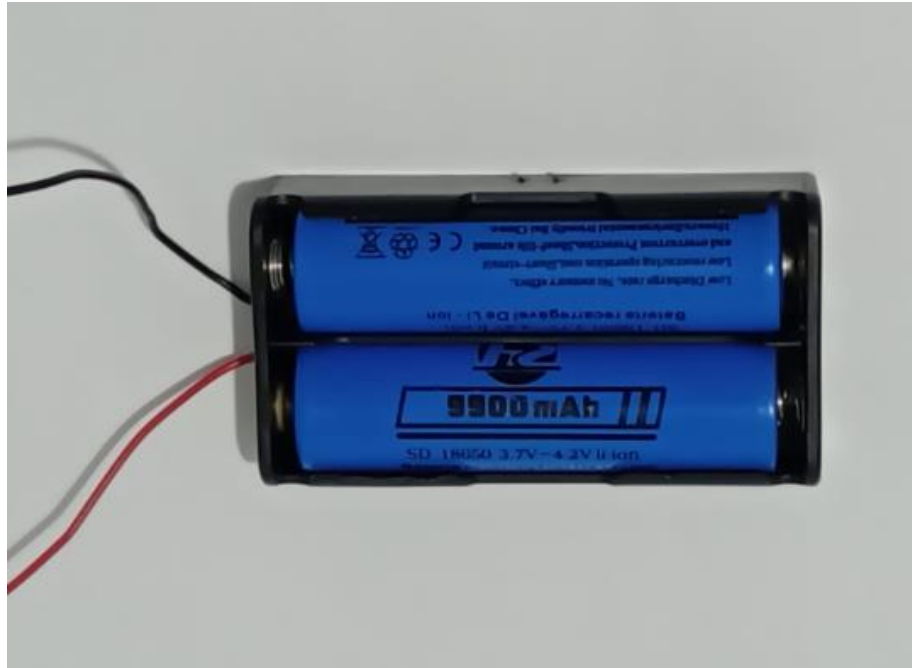
Figura 11 – Baterias de íon de lítio em série que compõem o Módulo de energia.
