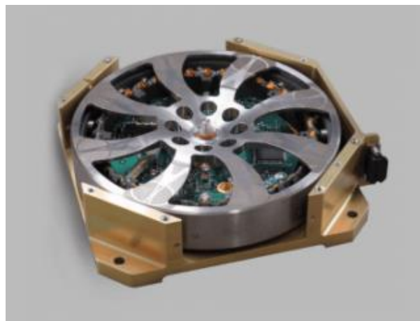
Figura 6 – Exemplo de roda de reação responsável por movimentar o CubeSat .
