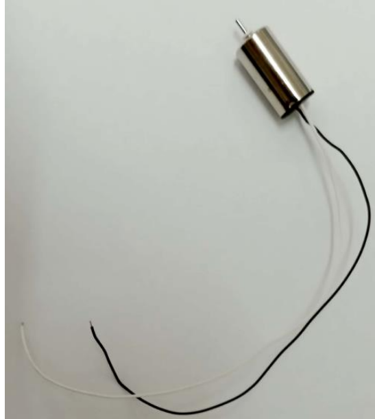
Figura 14 – Motor CC Coreless 1020A utilizado no módulo de controle.
