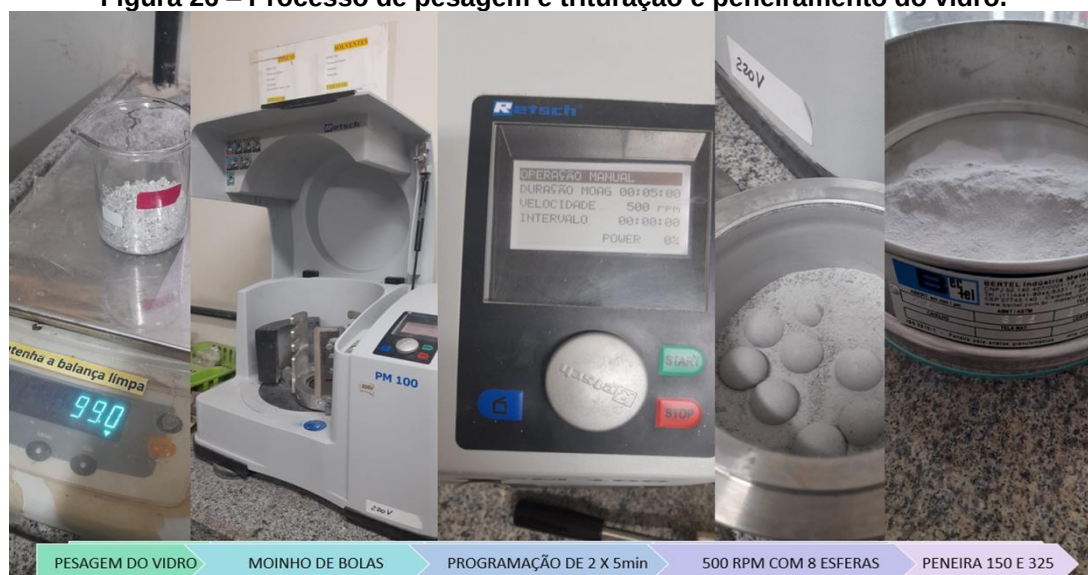
Figura 26 – Processo de pesagem e trituração e peneiramento do vidro.
