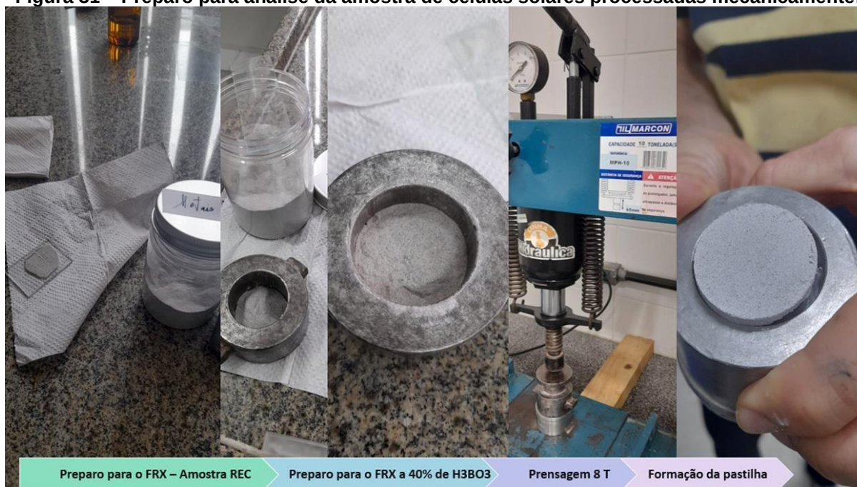
Figura 31 – Preparo para análise da amostra de células solares processadas mecanicamente.
