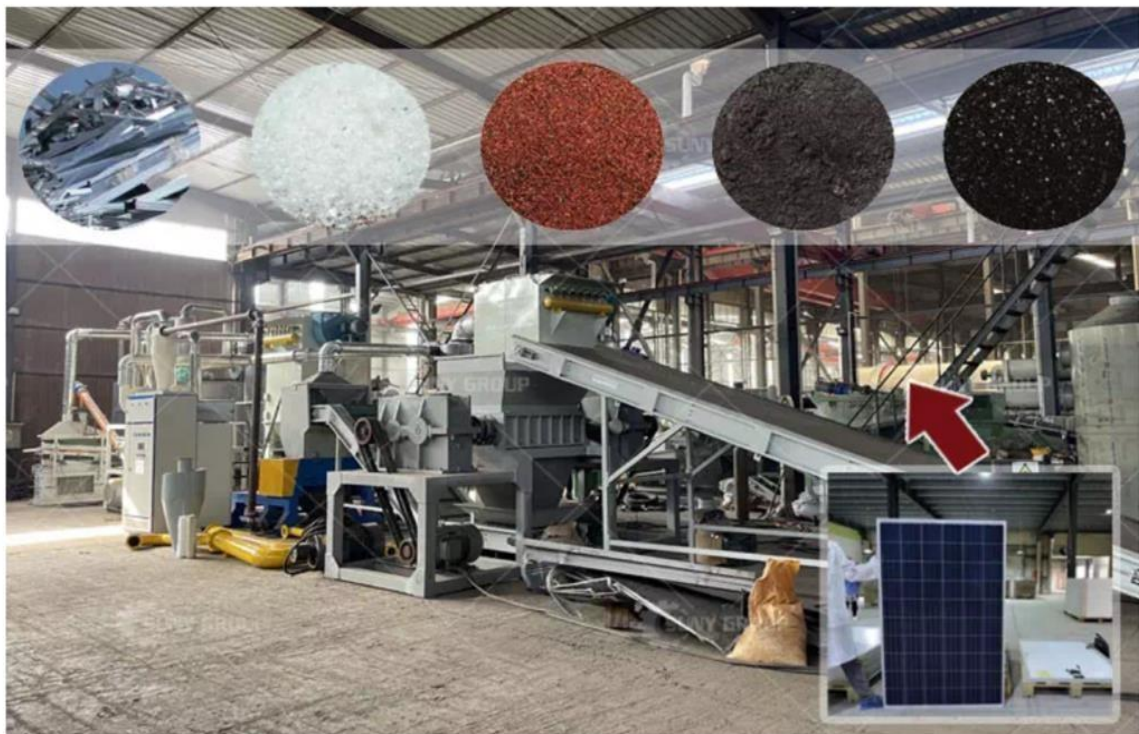
Figura 22 – Equipamento industrial para reciclagem de módulos solares na China.
