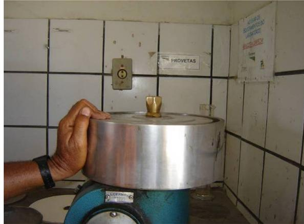
(a) e (b) Colocação da gasolina para extração do betume no Rotarex (equipamento utilizado na extração do betume)
