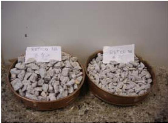
(a) Separação das amostras de agregados
