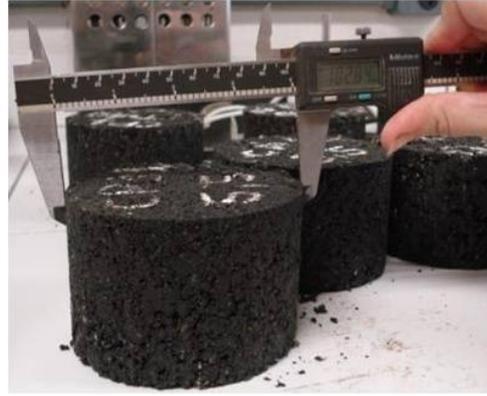
(b) Medição dos corpos de prova
