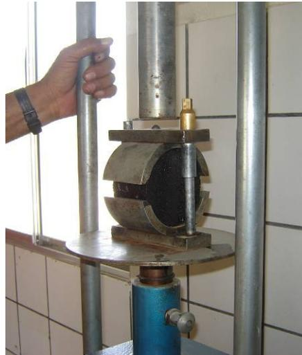
(c) Determinação da Estabilidade e Fluência
