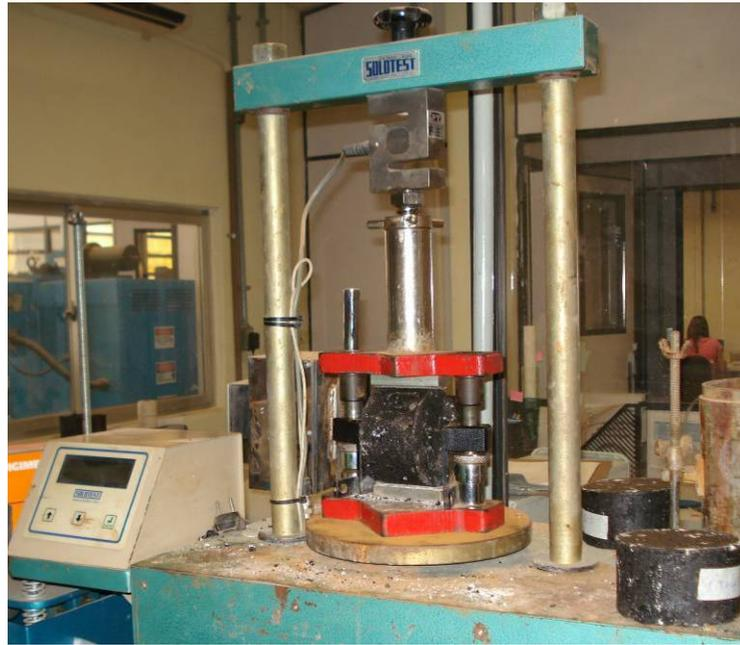
(a) Colocação do corpo de prova no dispositivo centralizador, na prensa, para realização do ensaio.
