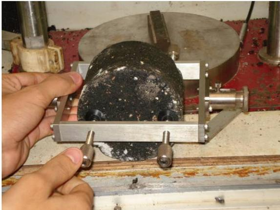
(a) Posicionamento do corpo de prova.
