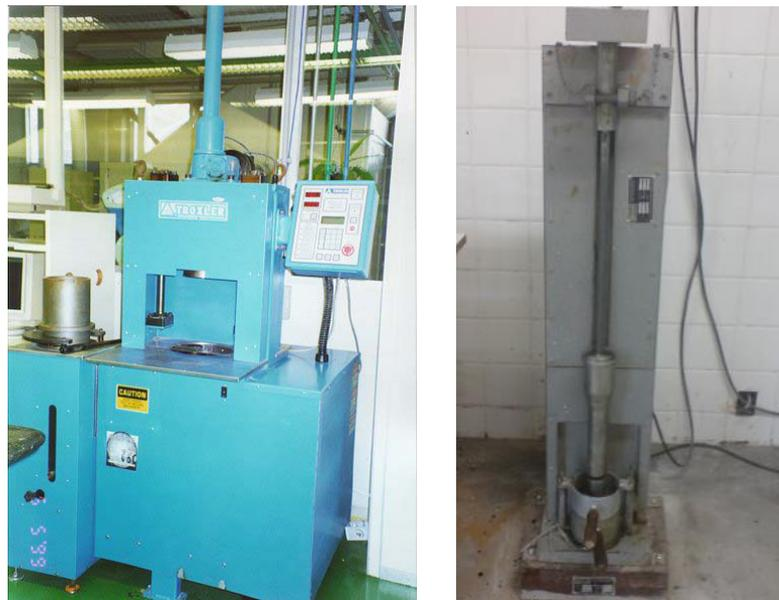
**Figura 3 – (a) Compactador giratório *Superpave* e (b) Compactador Marshall (automático).**
