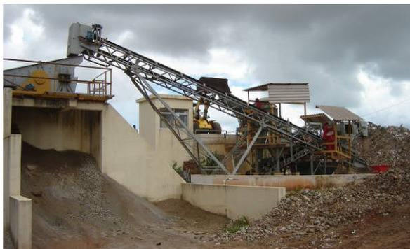
**(d) Produção do agregado reciclado de concreto.**
