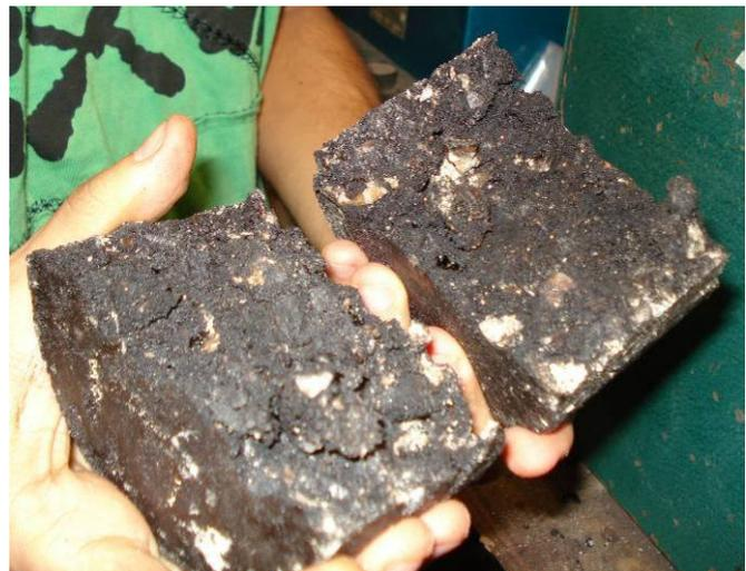
(c) Corpo de prova após o rompimento.
