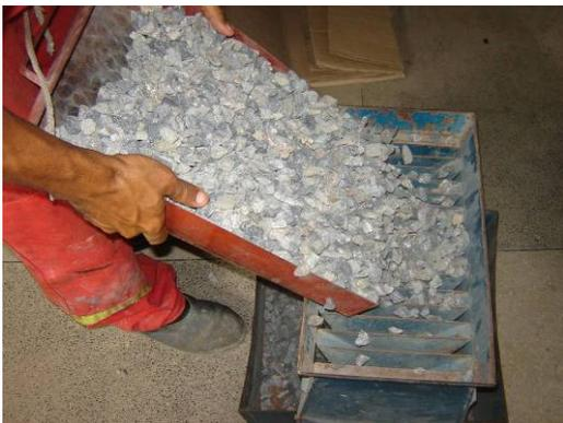
(a) Redução da amostra de agregado
