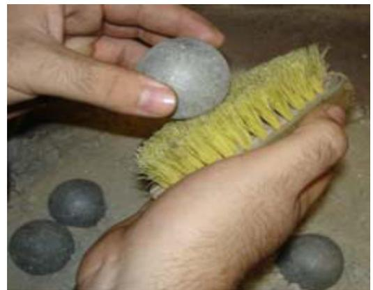
(d) Limpeza das esferas após realização do ensaio
