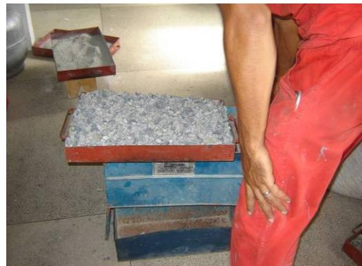
(b) Separação dos agregados para as misturas
