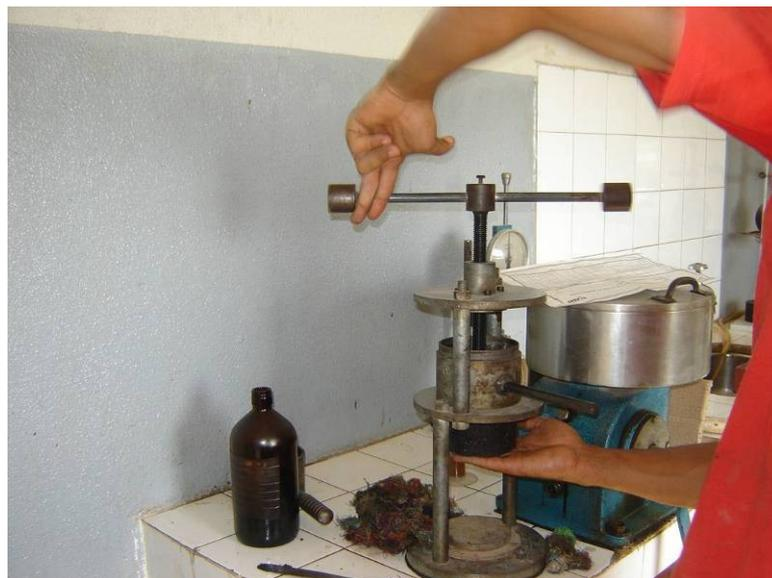
(g) Desmoldagem do corpo de prova
