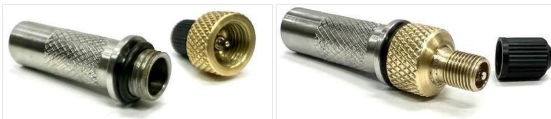
Figura 8. Jarro J1 acoplado com válvula Schrader soldada na superfície da tampa.
