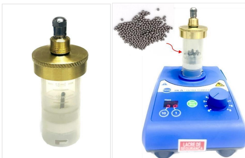
Figura 11. Jarro J2 com tampa projetada e produzida, equipada com válvula Schrader (esquerda) e UTTD IKA Workstation como moinho vertical de bolas adaptado de 5mm com o jarro J2 acoplado (direita).
