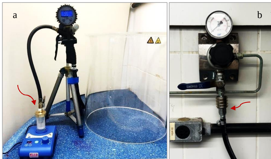
Figura 17. Sistema de injeção de gás nitrogênio no jarro de moagem (a) e regulador de pressão (b).
