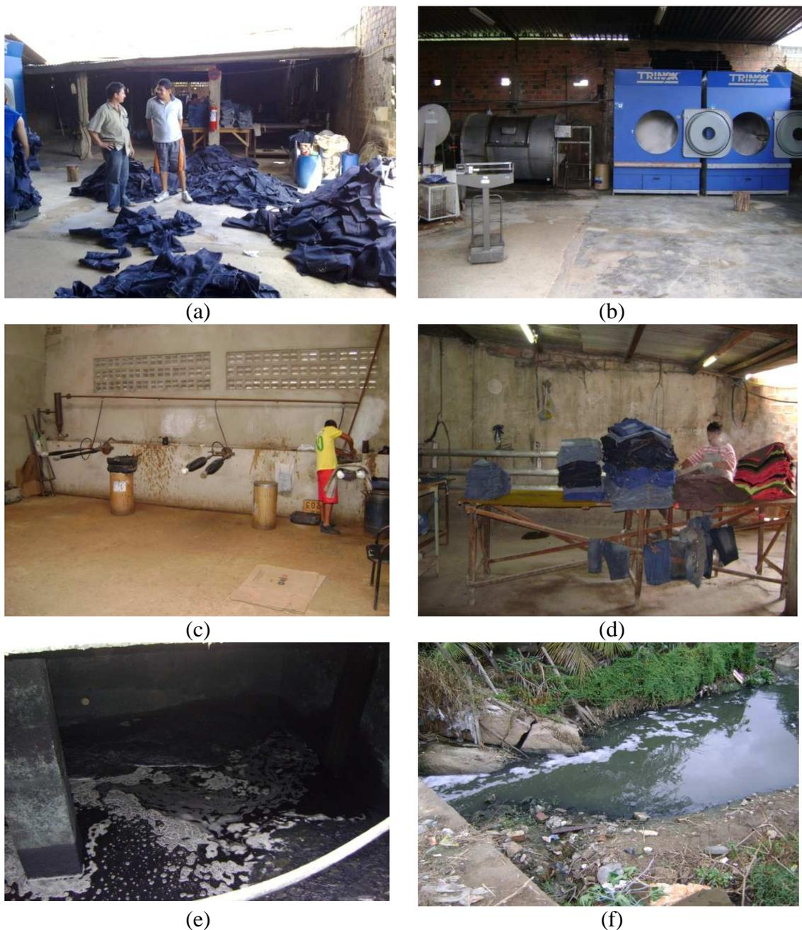
Figura 2. Fotografias ilustrativas de uma lavanderia de jeans de médio porte do APL da confecção do agreste pernambucano: (a) recebimento das peças para lavagem; (b) máquinas de lavagem e centrifugação, (c) beneficiamento das peças produzidas; (d) acabamento (passadoria); (e) efluente no tanque de equalização da empresa e (f) trecho do riacho receptor do efluente têxtil tratado.
