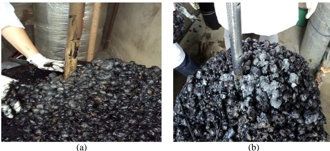
Figura 22. Material suporte do BAS, quando da abertura do reator para manutenção: (a) em agosto de 2010, (b) em fevereiro de 2011.
