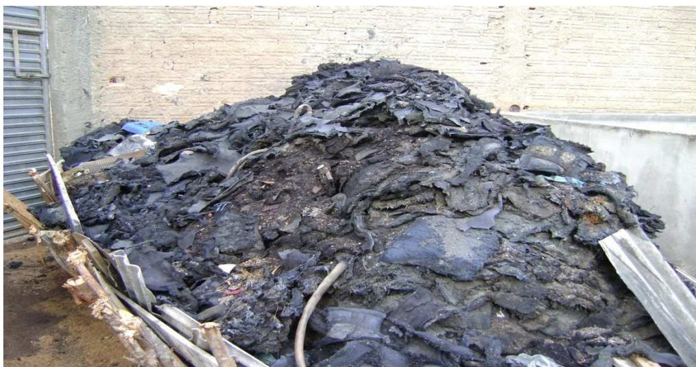
Figura 3. Lodo proveniente do processo físico-químico de tratamento, acumulado em lavanderia da região, aguardando destinação final (aterro sanitário).
