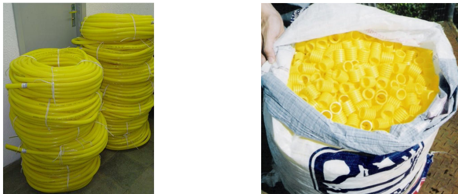
Figura 4.3 - Conduítes utilizados como meio suporte para os filtros biológicos. Inteiros (dir.) e cortados (esq.)
