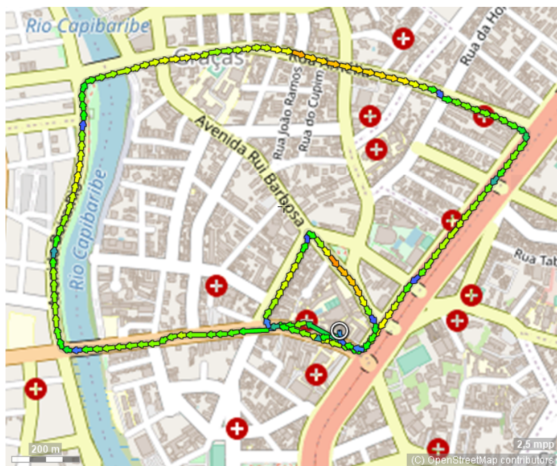
Figura 3.6: Dados Armazenados no Cartão SD após Teste Feito no Bairro das Graças, Recife - PE, Fonte: O Autor
