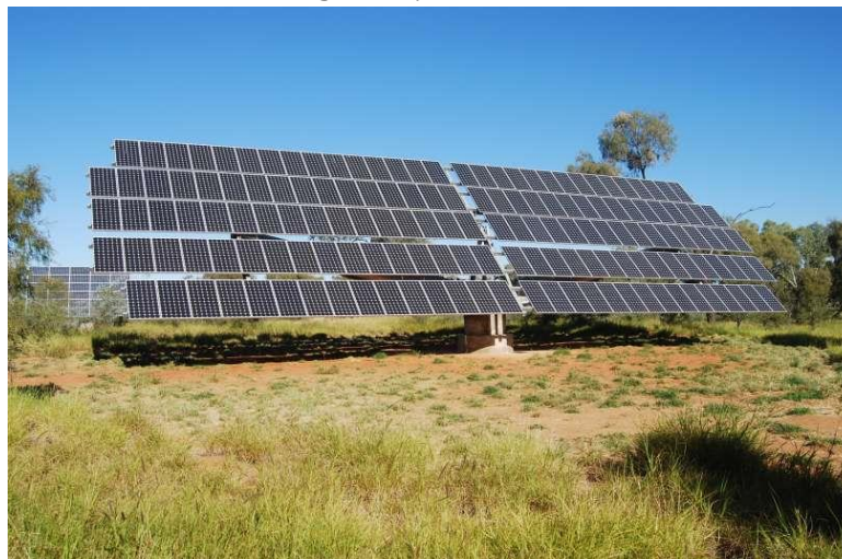
Figura 49 - Sistema Fotovoltaico do sítio 2 do DKASC, com rastreador duplo de azimute-altura, modelo ADES 5F-27M.
