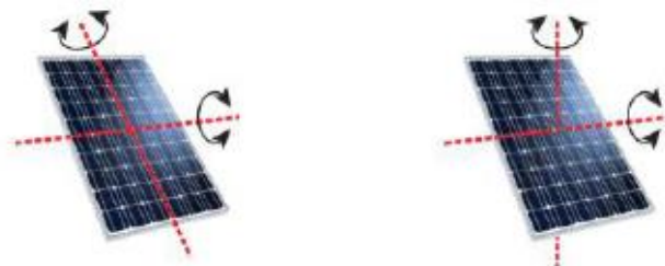
Figura 2 – Rastreadores de Inclinação de Ponta e de Azimute-Altura, respectivamente, e seus eixos de rotação.
