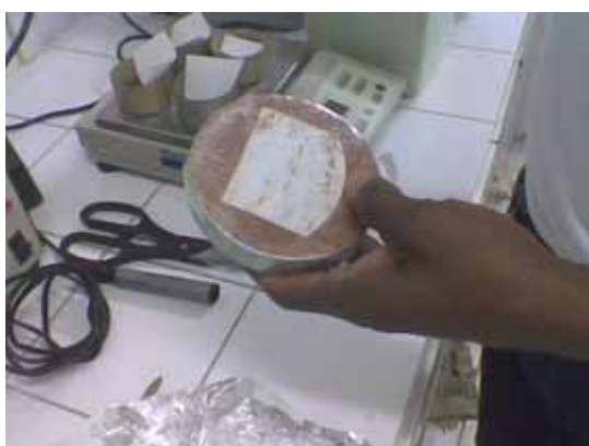
Figura 5.6 – Retirada do papel filtro da amostra de solo para pesagem e Retirada do papel filtro da amostra de solo para pesagem.
