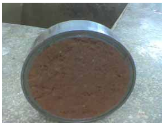
Figura 5.4 – Amostra moldada no anel, pronta para colocação do papel filtro.
