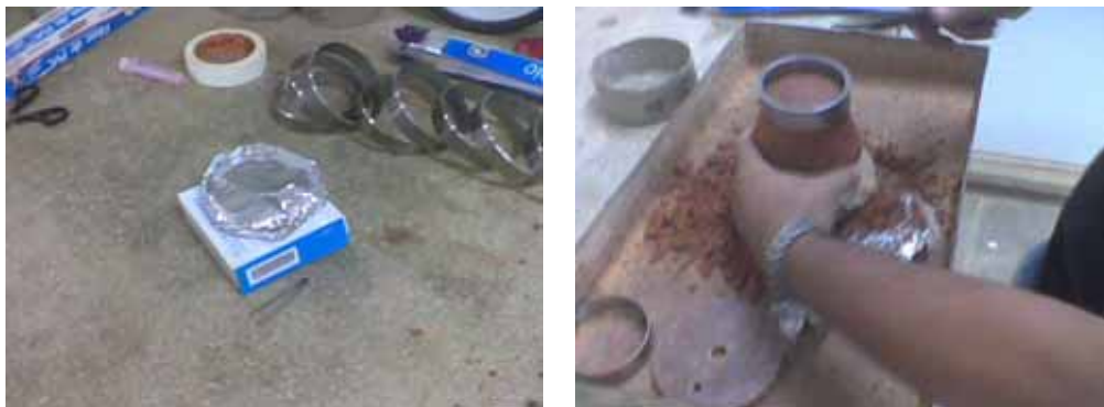
Figura 5.2 – material a ser utilizado no ensaio com papel filtro e cravação do anel na amostra compactada.
