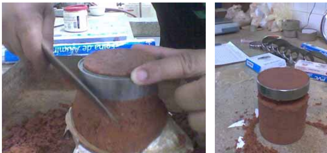
Figura 5.3 – Preparação da amostra na cravação do anel e Anel moldado no corpo de prova compactado.
