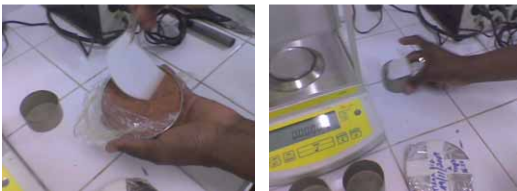
Figura 5.7 – Retirada do papel filtro em contato com a amostra para pesagem.
