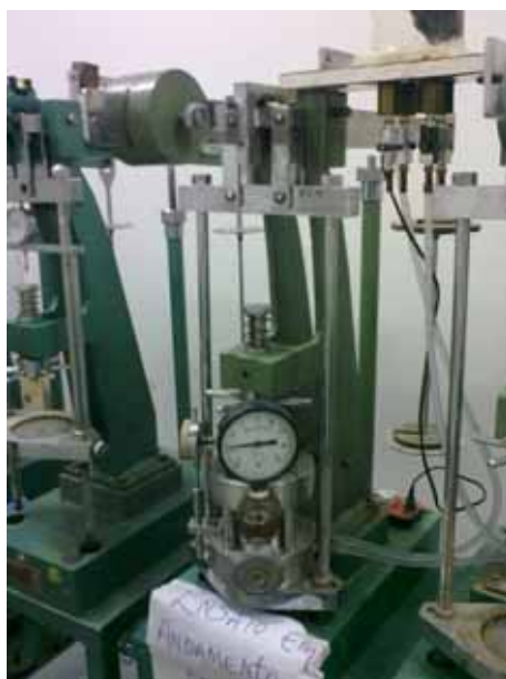
Figura 5.10 – Prensa para ensaio edométrico com sucção constante.
