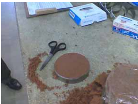
Figura 5.4 – Amostra moldada no anel, pronta para colocação do papel filtro.
