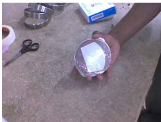
Figura 5.5 – Amostra moldada no anel com papel filtro, sendo envolvida no papel filme de PVC.
