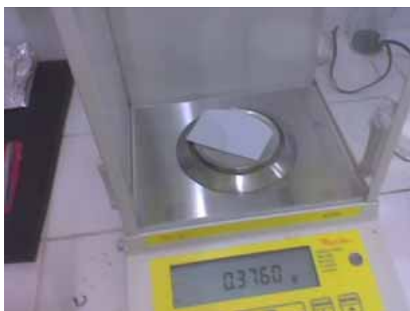
Figura 5.8 – Pesagem do papel filtro após ensaio.
