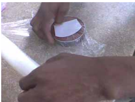
Figura 5.5 – Amostra moldada no anel com papel filtro, sendo envolvida no papel filme de PVC.
