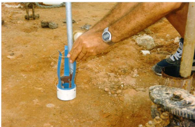
Foto 3.3. Medidor de recalque em profundidade (aranhas)
