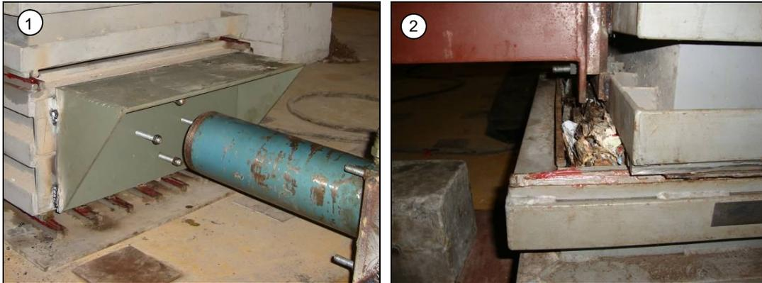
**Figura V.11. Detalhes do equipamento de cisalhamento: (1) base utilizada para fixação da célula de carga e mesa de proteção dos equipamentos e (2) deslocamento da caixa interior**
