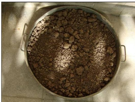
**Figura III.14. Amostra de lodo desidratado utilizado nos ensaios**
