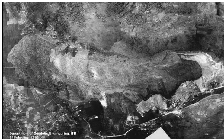
**Figura II.37. Imagem de satélite da ruptura do aterro de Leuwigajah (KÖLSCH *et al.*, 2005)**
