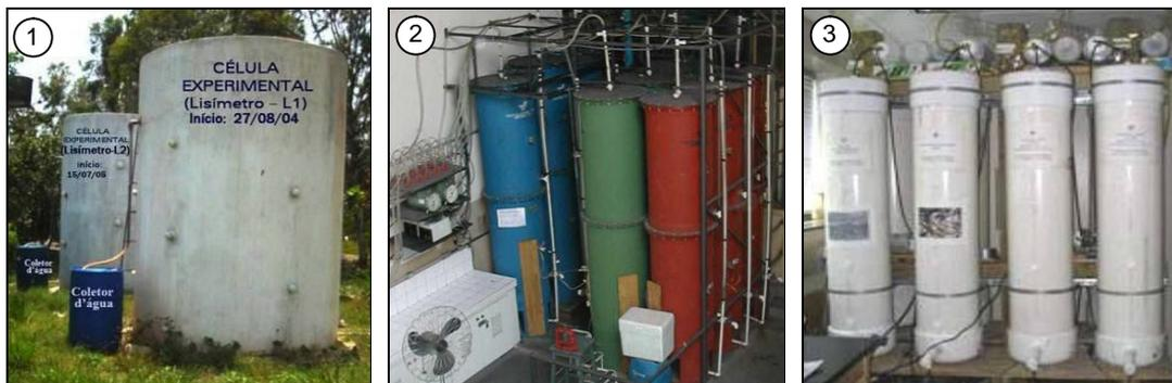
**Figura II.10. Experimentos em escala reduzida de campo e laboratório: (1) lisímetros em alvenaria - Alcântara (2007); (2) reatores em fibra de vidro – Cintra *et al.* (2005); reatores em PVC- Levine *et al.* (2005)**
