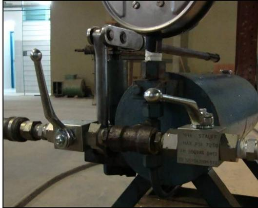
**Figura V.5. Válvulas instaladas na bomba**
