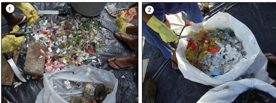
Figura VI.1. Pré-tratamento mecânico dos RSU: (1) plástico duro; (2) plástico mole
