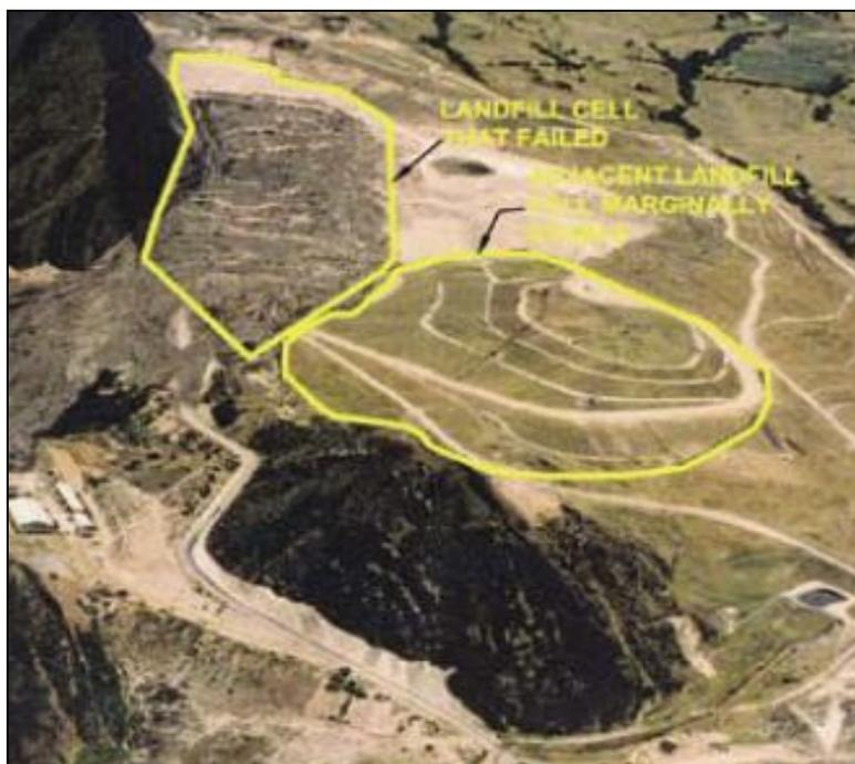
Figura II.35. Imagem do deslizamento do aterro de Doña Juana (COLLAZOS, 1998)
