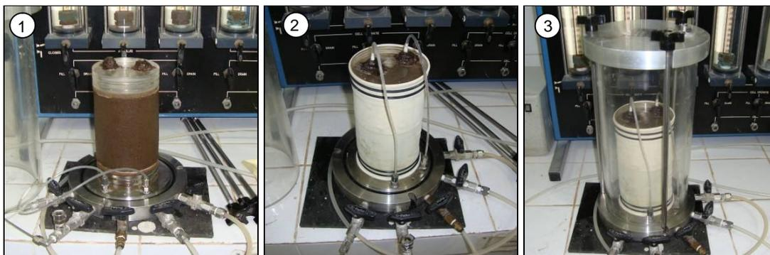
**Figura III.15. Procedimento para montagem da célula do ensaio: (1) disposição dos conjuntos pedras porosas e papel filtro e *top-cap*; (2) instalação da membrana de proteção; (3) célula de acrílico fechada**
