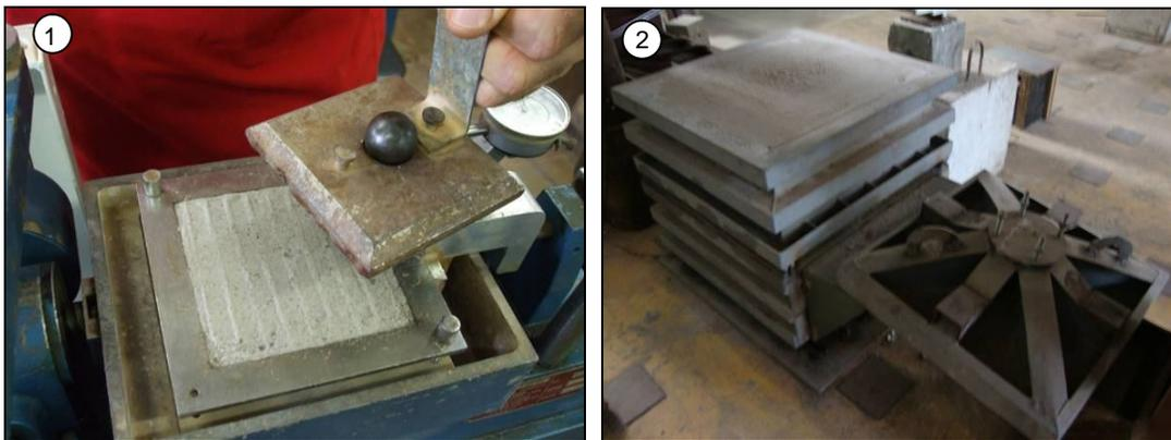
**Figura V.16. Corpos de prova utilizados para os testes do equipamento de cisalhamento direto desenvolvido: (1) ensaio convencional; (2) ensaio de grandes dimensões**
