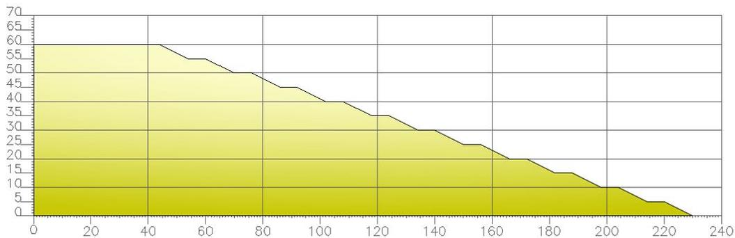
**Figura VII.1. Perfil dos taludes de RSU utilizado nas análises de estabilidade**
