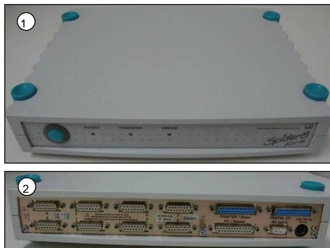
Figura V.14. Sistema de aquisição de dados - *Spider 8*: (1) vista frontal; (2) painel traseiro
