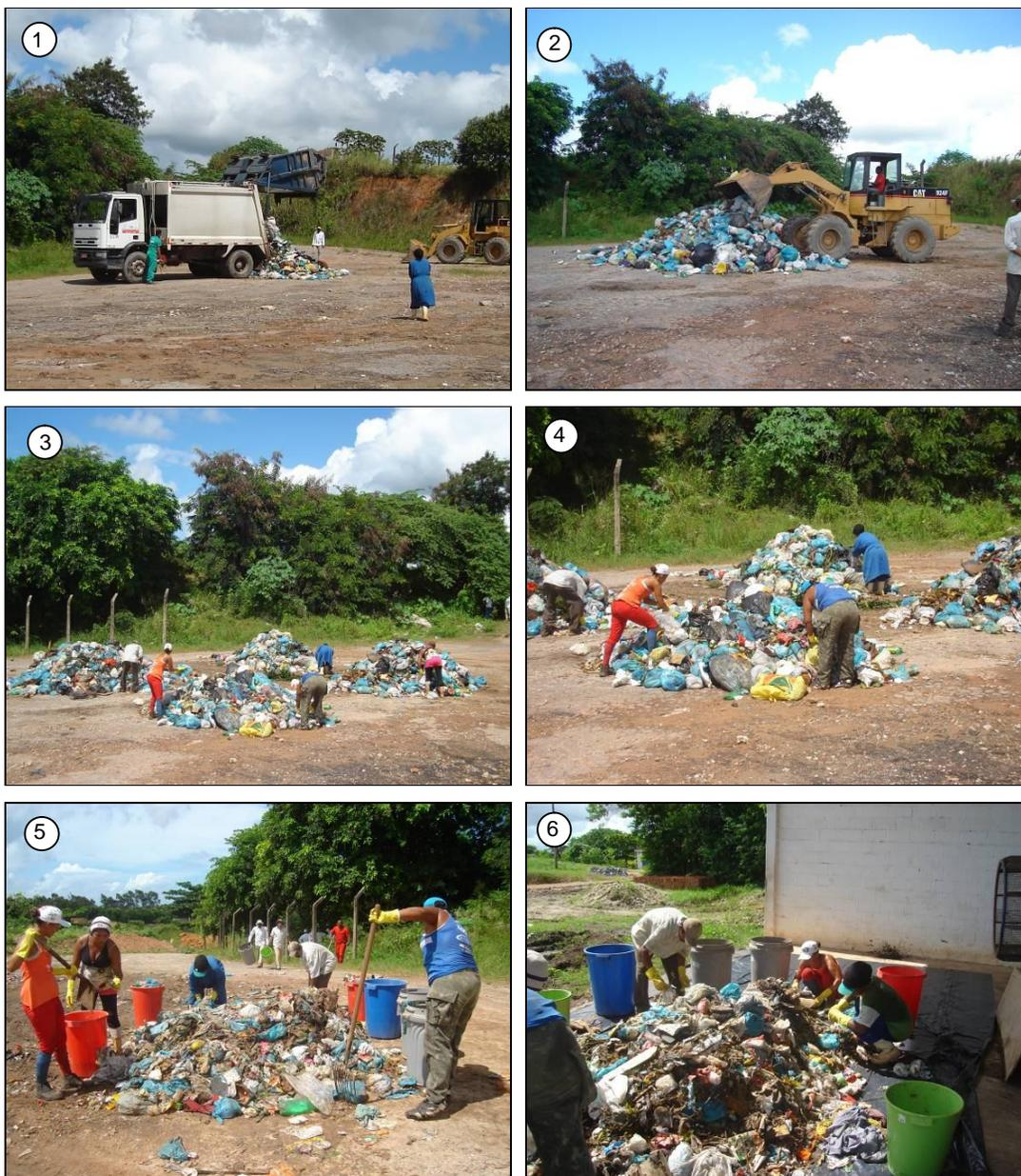
**Figura III.2. Procedimentos para caracterização dos RSU: (1) descarregando num pátio pavimentado; (2) homogeneização; (3) redução por quarteamento; (4) ruptura manual dos sacos plásticos; (5) pilha pronta para caracterização; (6) segregação dos componentes**
