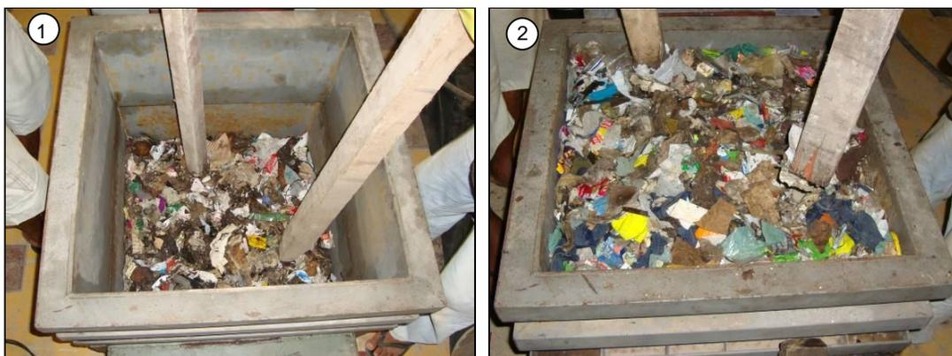
Figura VI.2. Moldagem do corpo de prova na caixa de cisalhamento: (1) RSU; (2) RSU-LE
