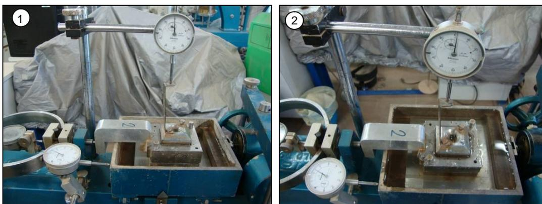
Figura III.17. Ensaios de cisalhamento direto do LE: (1) umidade natural; (2) inundado
