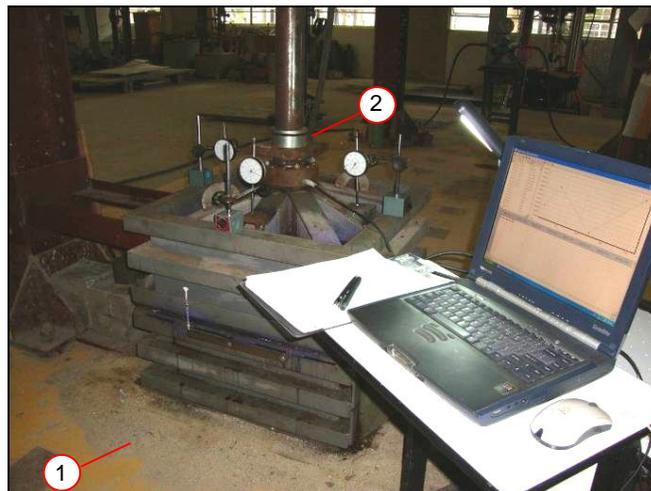
**Figura V.12. Equipamento de cisalhamento direto de grandes dimensões: (1) base envolvida com areia; (2) rótula para apoio do êmbolo do cilindro hidráulico**
