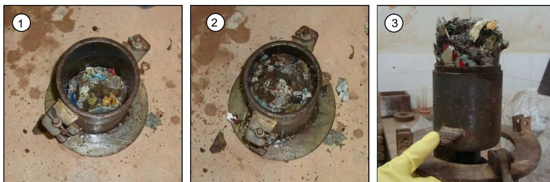
**Figura III.5. Apresentação do cilindro utilizado para os ensaios de compactação: (1) após compactação da segunda camada de RSU-LE; (2) após compactação da terceira camada de RSU-LE; (3) extração do corpo de prova de RSU**
