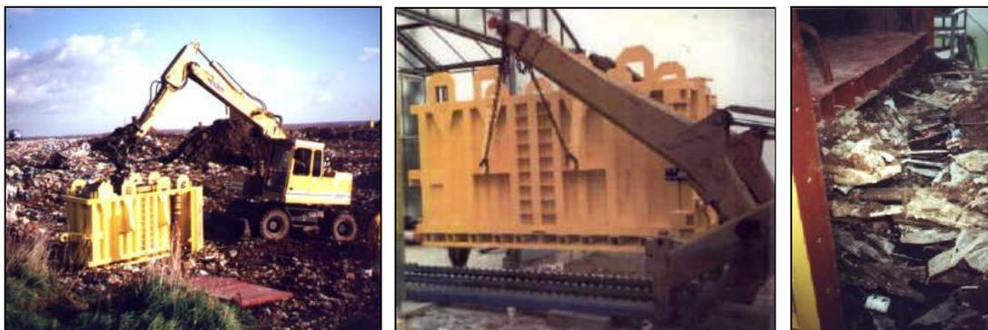
Figura II.19. Coleta de amostra, transporte e realização do ensaio de tração (KÖLSCH, 1996)
