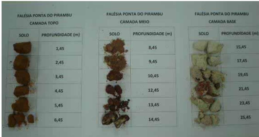
Figura 7.4. Amostras de solo do perfil geotécnico da falésia da Ponta do Pirambu
