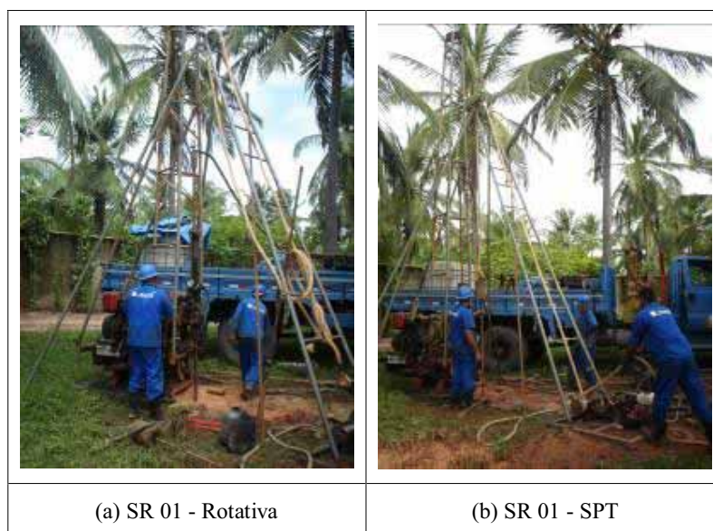
Figura 5.4. Sondagem mista (SPT + rotativa)
