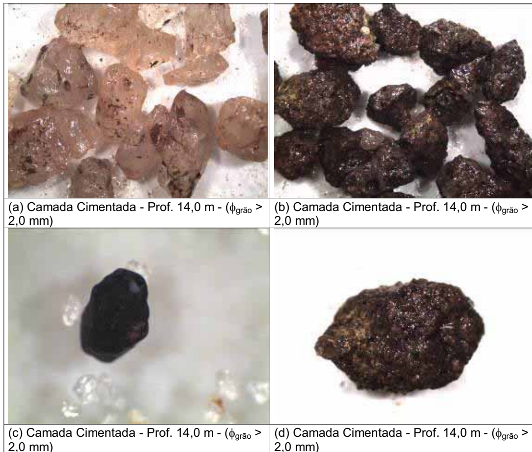
Figura 5.16. Análise mineralógica morfoscópica fração pedregulho da camada fortemente cimentada
